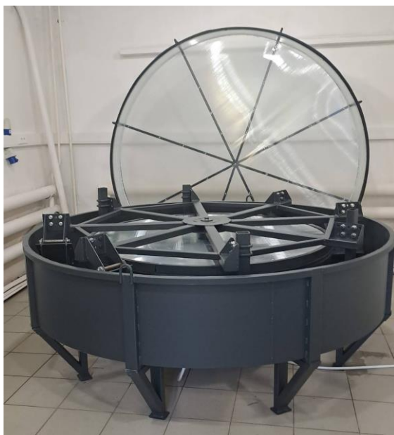
Рисунок 3.13 – Внешний вид почвенного кругового стенда
