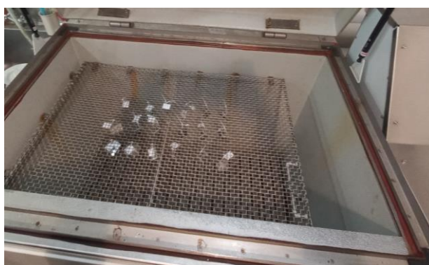
Рисунок 4.36 – Образцы после испытаний в камере соляного тумана
