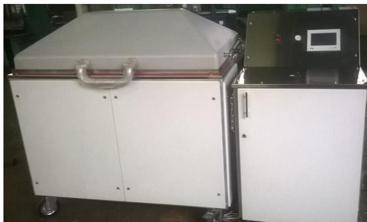
Рисунок 3.11 - Камера соляного тумана КСТ-18/001
