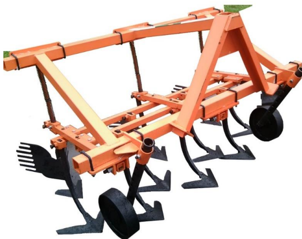
Рисунок 3.14 – Культиватор-окучник навесной КОН-2,8
