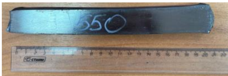
Рисунок 4.4 – Лист стали 0,43С-1,60Si-0,01Mn-1,1Cr-0,95Mo-0,08V-0,05Nb-0,04Ti после прокатки при температуре 550 °С до степени деформации 0,89
