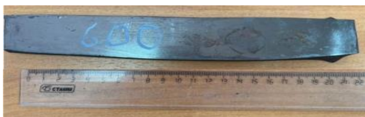
Рисунок 4.5 – Лист стали 0,43С-1,60Si-0,01Mn-1,1Cr-0,95Mo-0,08V-0,05Nb-0,04Ti после прокатки при температуре 600 °С до степени деформации 0,89
