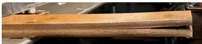
Рисунок 4.3 – Раскрытие трещины на листе стали 0,43С-1,60Si-0,01Mn-1,1Cr-0,95Mo-0,08V-0,05Nb-0,04Ti после деформационно-термической обработки при температуре 500 °С до степени деформации 0,85
