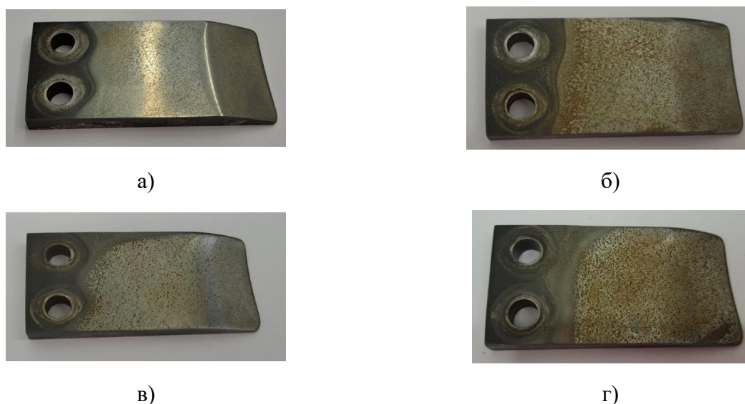
Рисунок 4.33 – Сталь 0,34C-1,77Si-1,35Mn-0,56Cr-0,20Mo-0,04Nb-0,031Ti с термической обработкой закалка-распределение после: а) 40 часов; б) 80 часов; в) 120 часов; г) 160 часов испытаний
