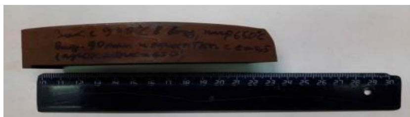
Рисунок 4.6 – Лист стали 0,43С-1,60Si-0,01Mn-1,1Cr-0,95Mo-0,08V-0,05Nb-0,04Ti после прокатки при температуре 650 °С до степени деформации 0,5
