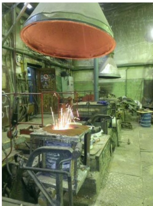
Рисунок 5.1 – Процесс выплавки стали в открытой индукционной печи ИСТ 016
