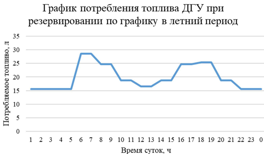
Рисунок 3.2.7 – Суточный график потребляемого топлива предприятием КРС (ферма + телятник) в летний период времени при резервировании по графику при использовании ДГУ АД-250С-Т400-1РПМ11
