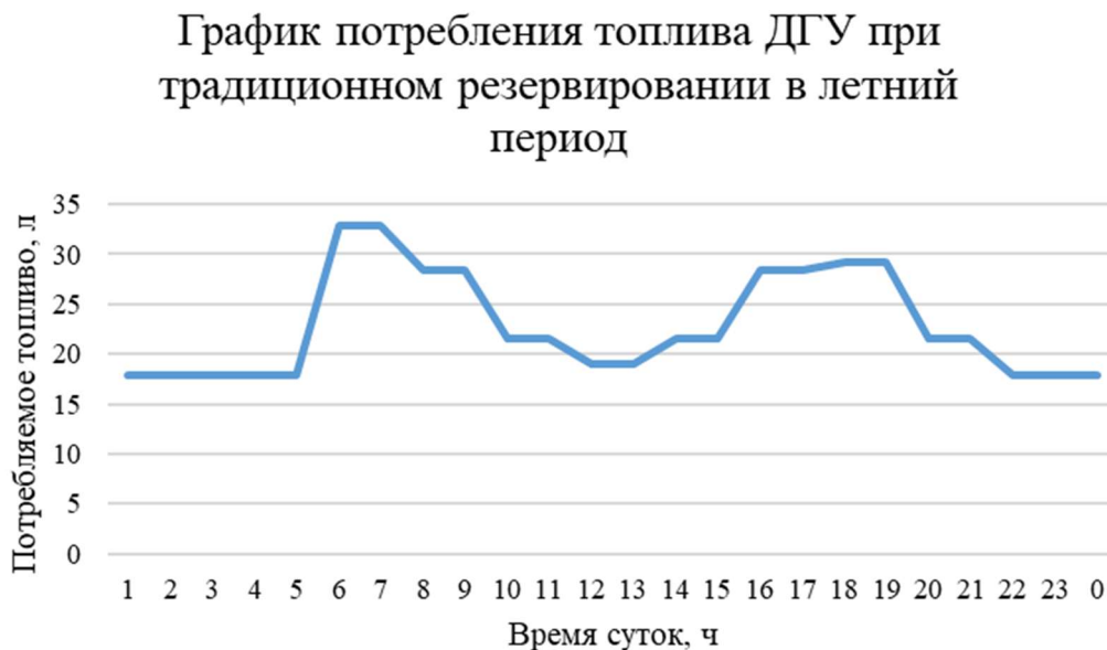
Рисунок 3.2.5 – Суточный график потребляемого топлива предприятием КРС (ферма + телятник) в летний период времени при традиционном резервировании при использовании ДГУ АД-315С-Т400-1РПМ2
