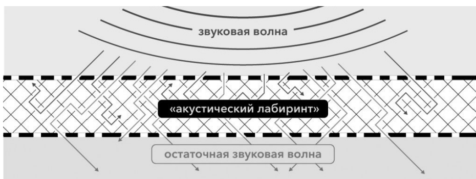
Рисунок 3.1 – Принцип действия звукопоглощающих материалов
