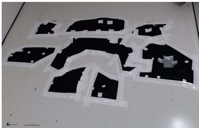
Рисунок 3.22 – Обивки звукопоглощающие моторного отсека в испытательной установке
