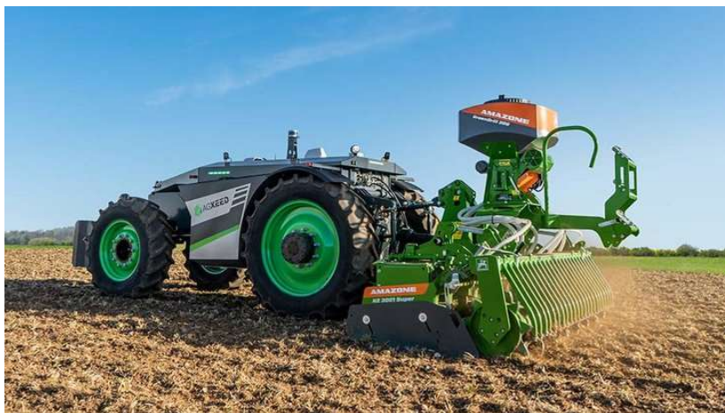
Рисунок 1.3 – Беспилотный трактор AgBot 2.055W4 от компании AgXeed
