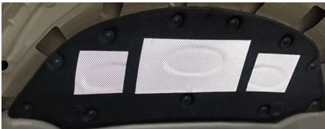
Рисунок 3.33 — Звукопоглощающая деталь моторного отсека с использованием термоэкрана
