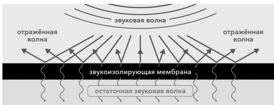
Рисунок 3.2 – Принцип действия звукоизолирующих материалов
