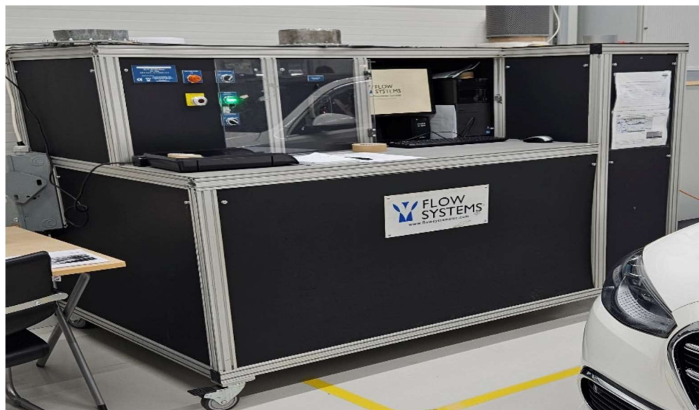
Рисунок 2.19 – Установка AirFlow для оценки герметичности ТС
