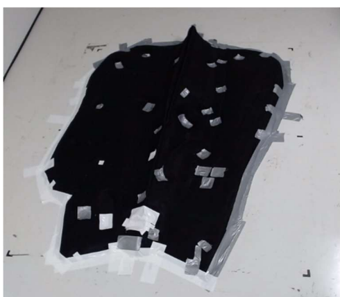
Рисунок 13а – Обивка тоннеля пола в испытательной установке
