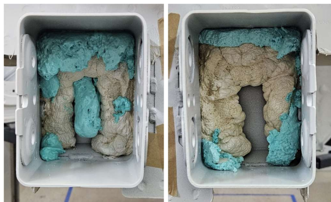
Рисунок 3 — Доработка герметизации элементов кузова после проведения замеров
