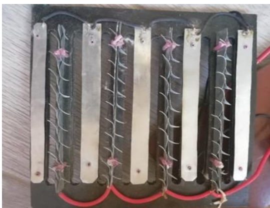
Рисунок 4.4 – Пластина с коронирующими и заземленными электродами
