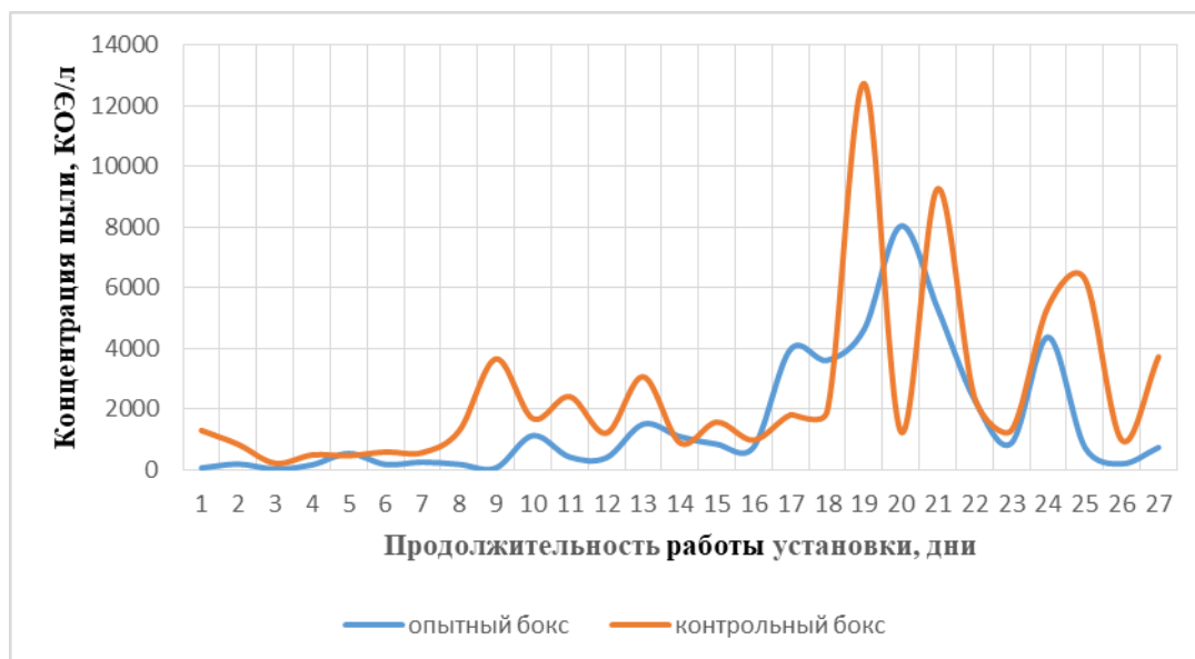
Рисунок 5.17 – Зависимость концентрации пыли 0,3 мкм от в опытном и контрольном боксах
