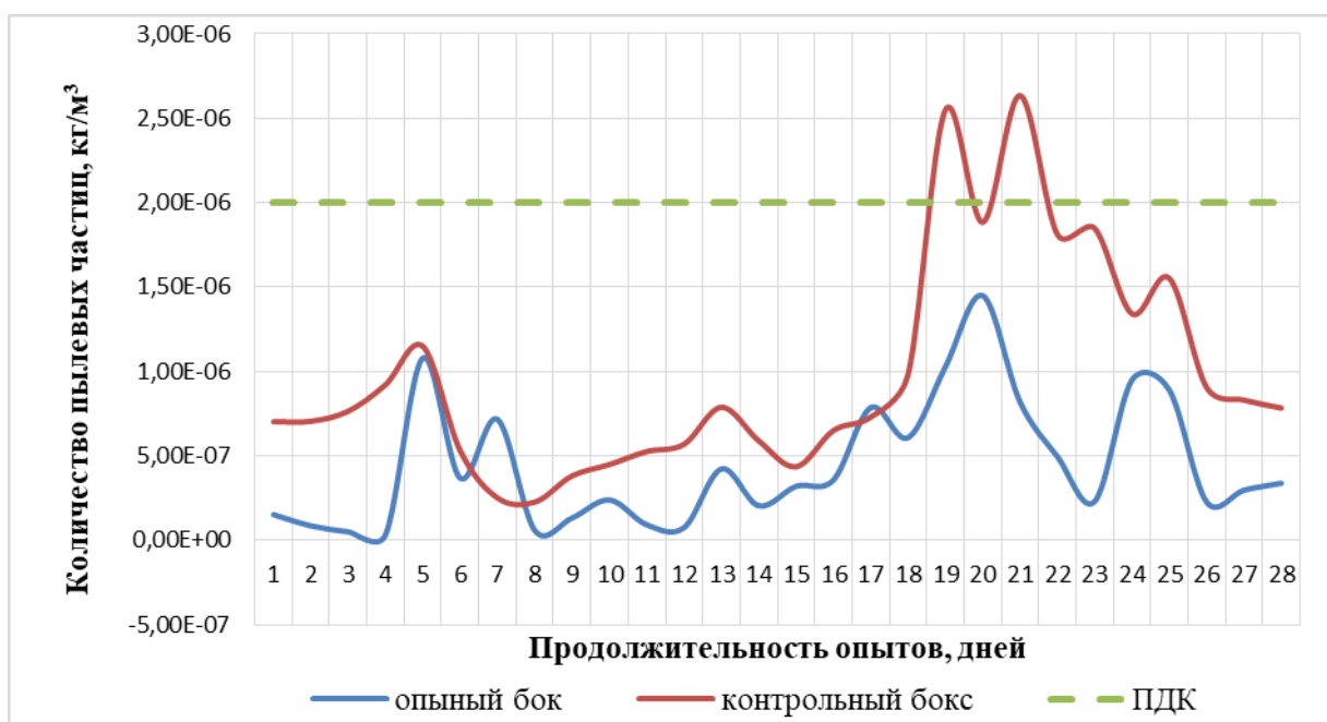
Рисунок 5.18 – Зависимость концентрации пыли от продолжительности работы электроустановки в опытном и контрольном боксах
