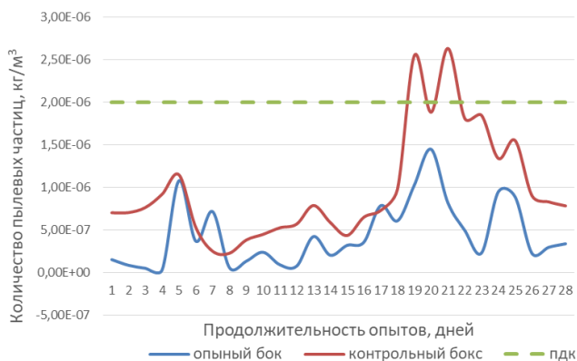
Рисунок 7 – Зависимость концентрации пыли размеров от 0,3 до 1 мкм от продолжительности работы комбинированной электроустановки
