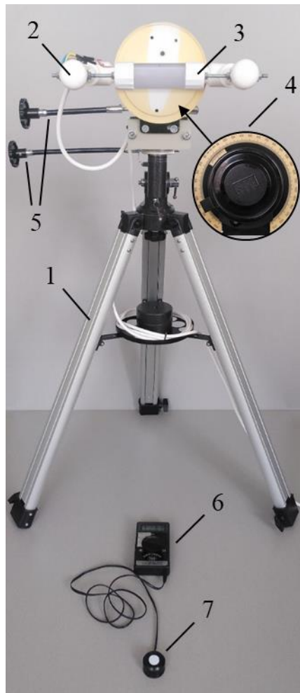
Рисунок 3.5 – Экспериментальная гениофотометрическая установка для определение кривых сил света
