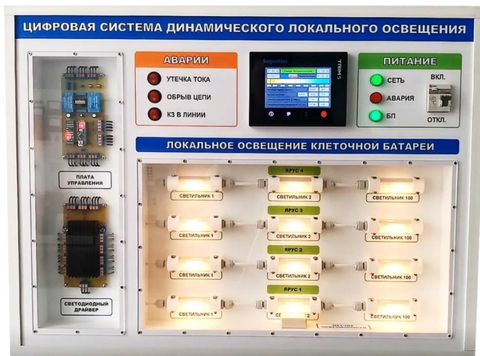
Рисунок 4.20 – Разработанный экспериментальный образец цифровой системы динамического локального светодиодного освещения
