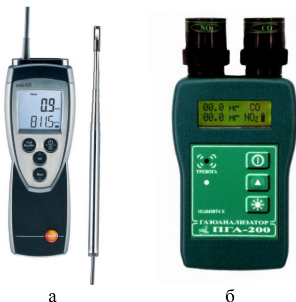
Рисунок 4.5 – Общий вид измерительных приборов: где а – термогигрометр Testo-425; б – газоанализатор ПГА-200
