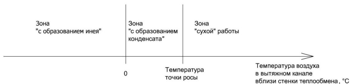
Рисунок 1 – Режимы работы рекуператора «с образованием инея»
