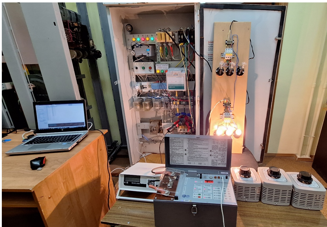
Рисунок 4.21 - Эксперимент по имитации короткого замыкания в ЛЭП.
