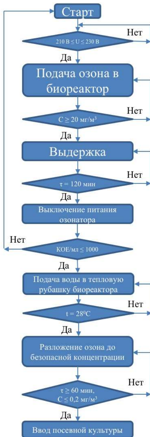
Рисунок 4.9 Алгоритм электротехнологического процесса дезинфекции биореактора
