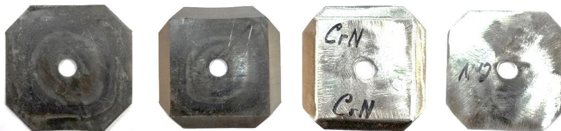
Рисунок 3.2 – Экспериментальные образцы: а – сталь 9ХС; б – сталь 9ХС с покрытием поверхностным упрочнением (CrN)
