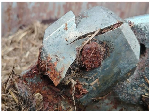
Продолжение рисунка 1.12 – Коррозионно-механическое изнашивание рабочих органов смесителей-кормораздатчиков
