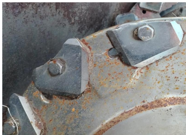
Продолжение рисунка 1.12 – Коррозионно-механическое изнашивание рабочих органов смесителей-кормораздатчиков
