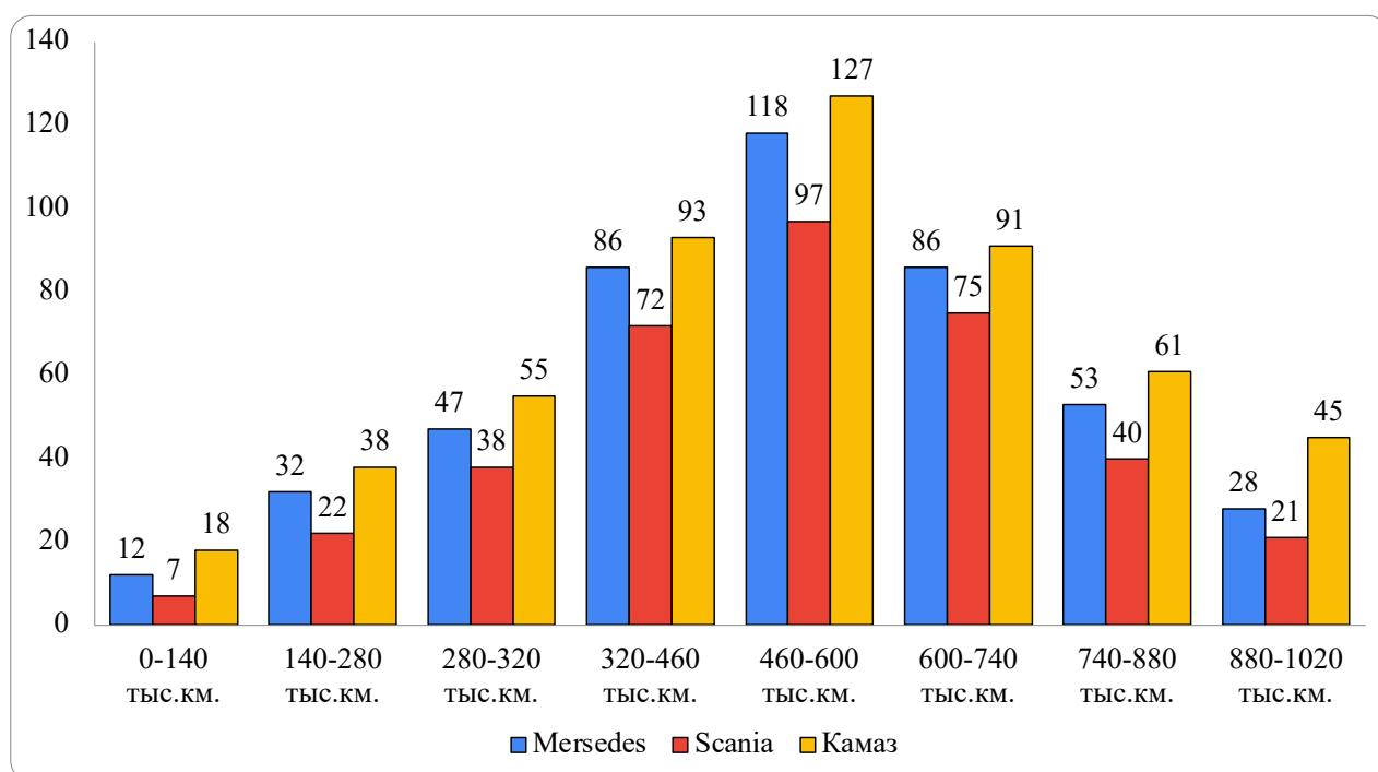
Рисунок 8 – Распределение отказов транспортных машин в зависимости от пробега
