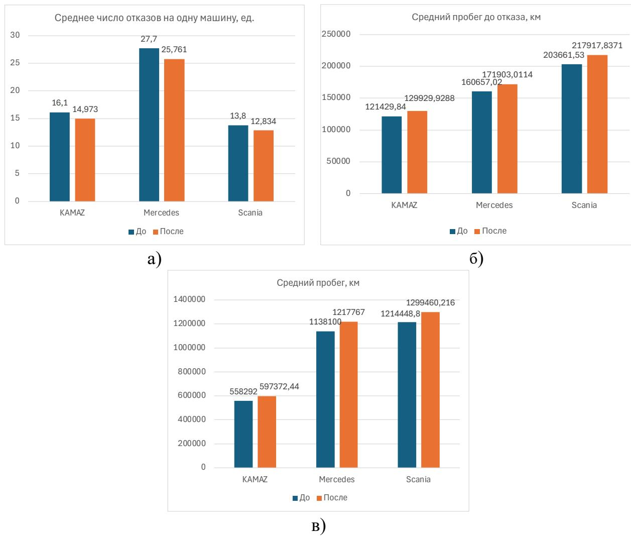
Рисунок 13 – Показатели безотказности транспортных машин при перевозке сельскохозяйственной продукции транспортной компанией «Технология Движения»
