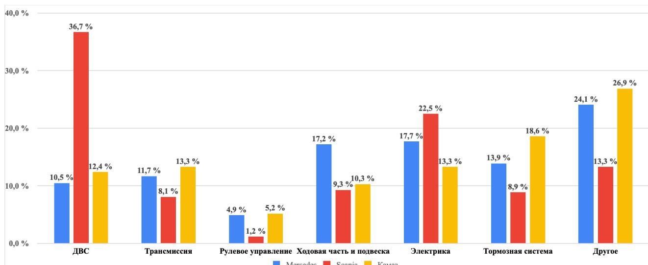
Рисунок 7– Сравнительная гистограмма распределения отказов по узлам транспортных машин
