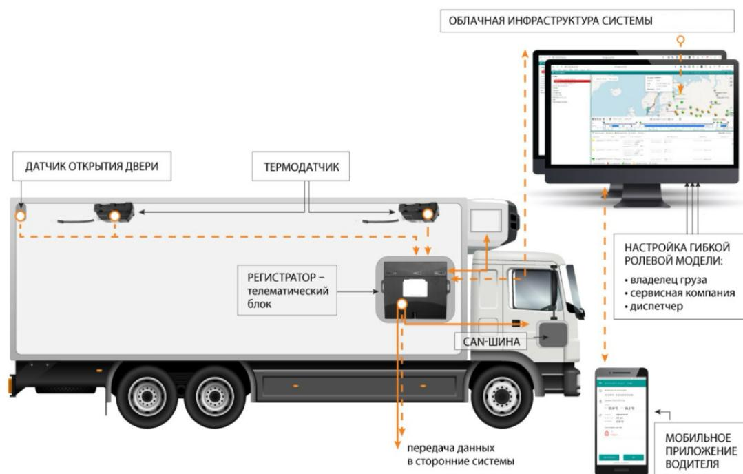
Рисунок 4 – Архитектура программно-аппаратного комплекса
