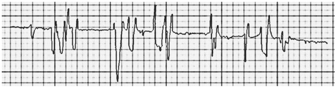
Рисунок 4.3. Участок профилограммы образца, царапанного бруском АСВ 125/100, М1, 50%
