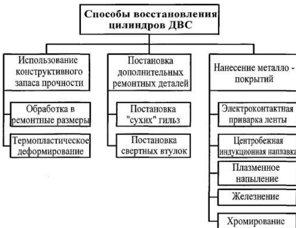
Рис. 1.5. Способы восстановления цилиндров ДВС
