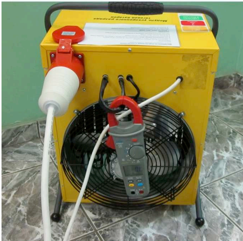
Рисунок 3.20 – Измерение тока разряда на модуле ускоренного разряда
