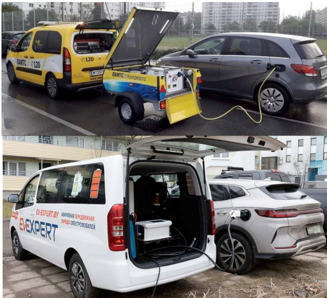
Рисунок 2.5 – Передвижной генератор (аккумулятор) [185, 186]
