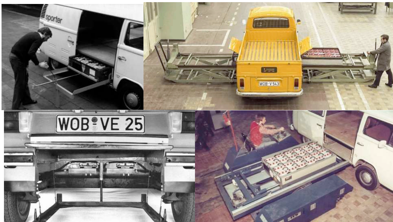
Рисунок 2.7 – Различные варианты станций замены батарей [188, 189]
