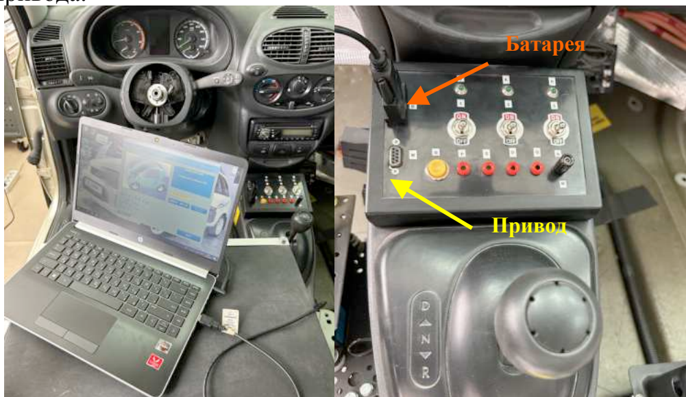
Рисунок 3.14 – Подключение диагностического борудования к стенду
