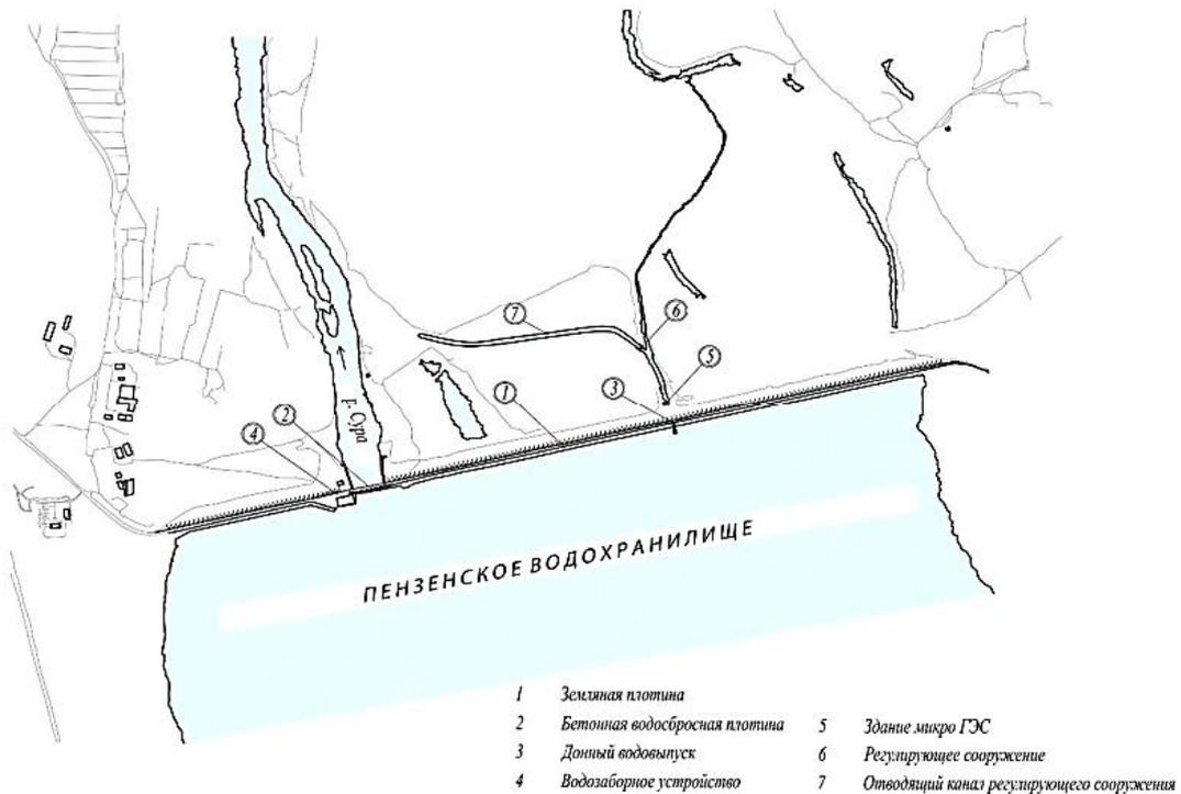
Рисунок 5.2 – Генплан Сурского гидроузла
