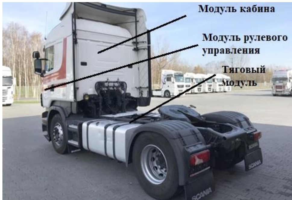
Рисунок 1.4 – Модульный автомобиль сельскохозяйственного назначения Scania
