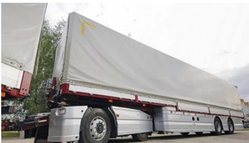
Рисунок 1.6 – Тяговый и грузовой модули Scania
