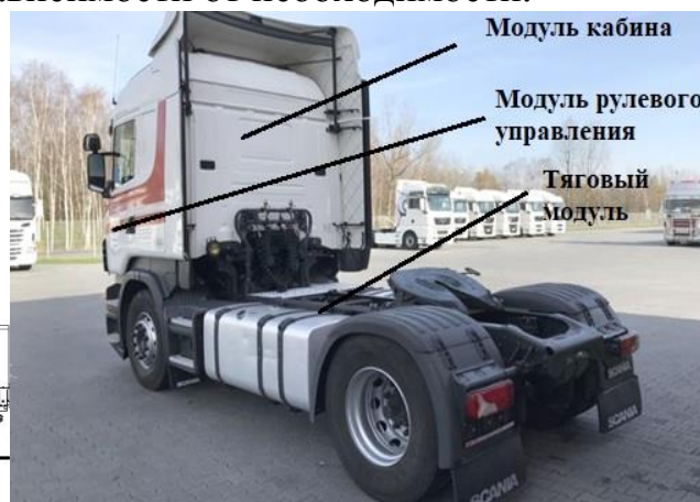
Рисунок 2 – Модульный автомобиль сельскохозяйственного назначения Scania
