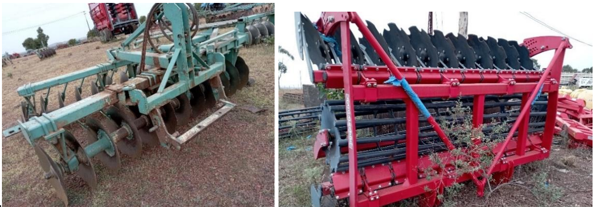
Рисунок 1.26 Комбинированная дисковая борона (слева) и дисковая борона с прикатывающим устройством в виде бруска (справа)
