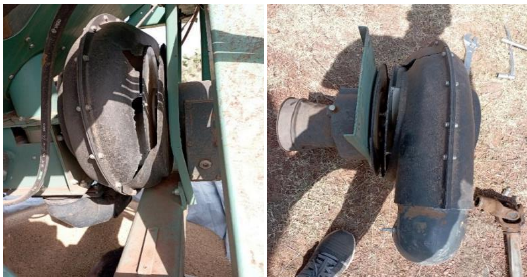
Рисунок 4.15 Повреждение вентилятора в процессе работы
