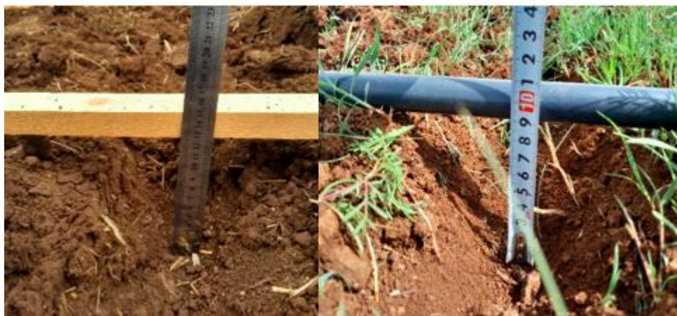
Рисунок 3.14 Фотографии, сделанные во время полевых измерений количества комков и неподрезанных сорняков, (поскольку операция проводилась до начала дождя, сорняки не выросли).
