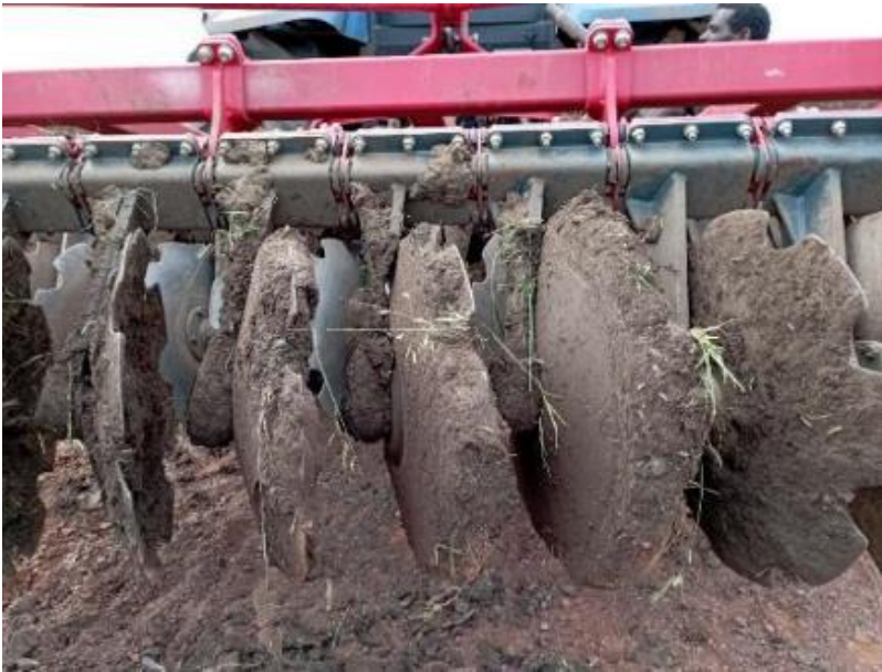
Рисунок 12 – Почва налипла на орудие
