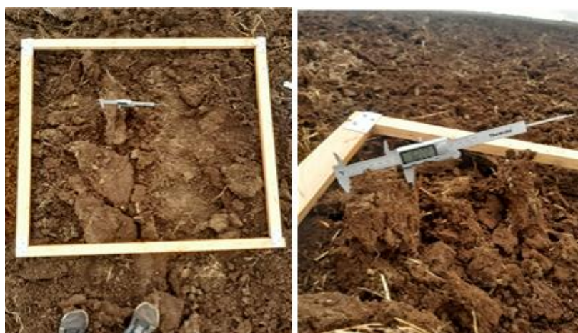
Рисунок 9 – Фотографии, сделанные во время полевых измерений количества комков и неподрезанных сорняков
