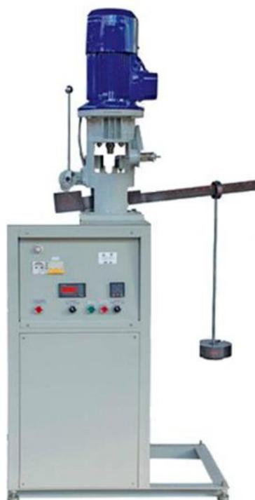
Рисунок 3.5 – Четырехшариковая машина трения ЧМТ-1
