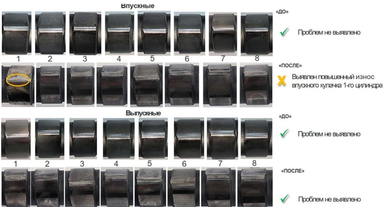
Рисунок 4.18 – Результаты испытаний кулачков распределительного вала
