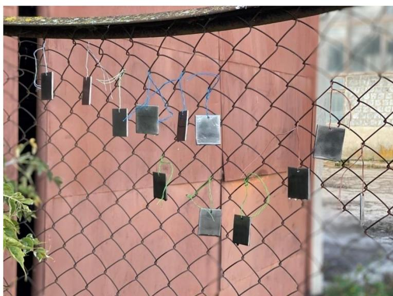
Рисунок 3.11 - Металлические образцы под прямым воздействием климатических факторов.
