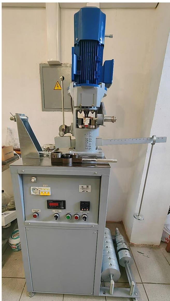
Рисунок 4.28 - Четырехшариковая машина трения (ЧМТ-1)
