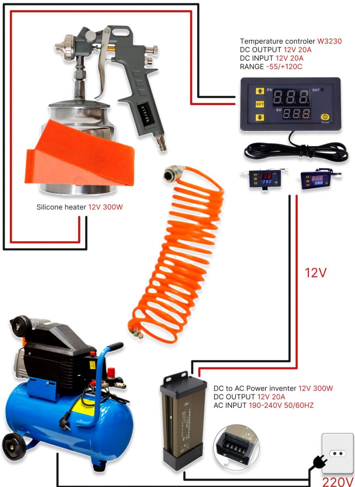
Рисунок 5.1 – Схема устройства
