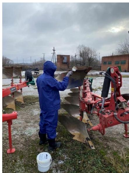
Рисунок 3.12 - Нанесение защитных покрытий с помощью малярной кисти
