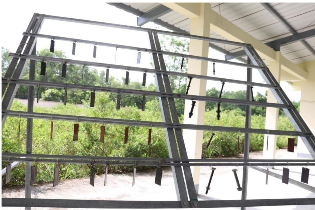
Рисунок 3.14 – Схема установки образцов для проведения натуральных испытаний
