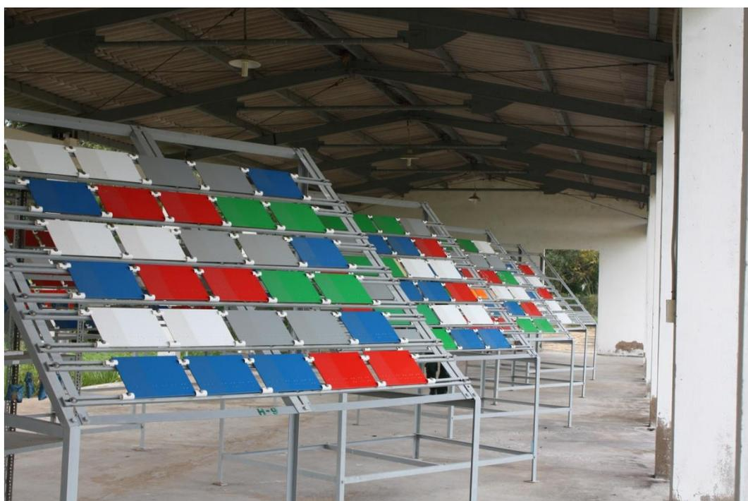
Рисунок 3.15 – Схема постановки образцов в условиях СРВ
