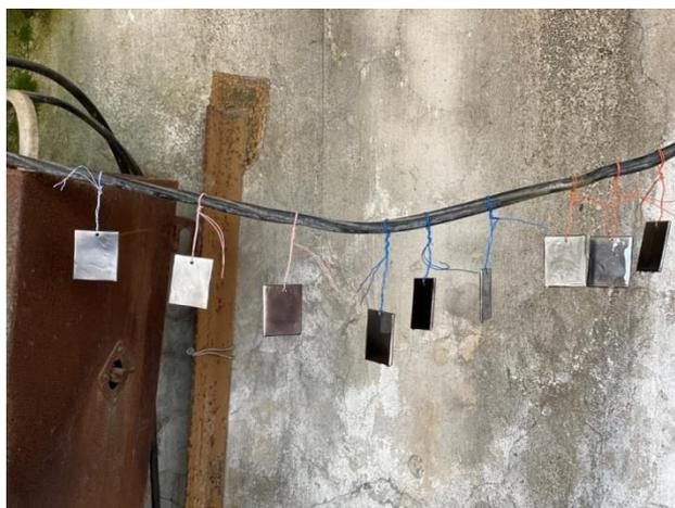
Рисунок 3.10 - Металлические образцы под навесом
