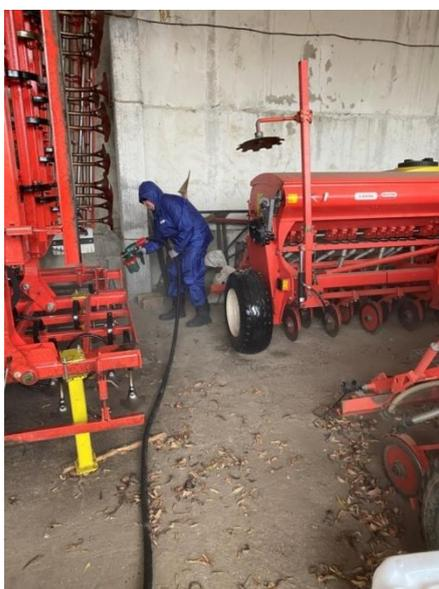
Рисунок 3.13 - Нанесения защитных материалов пульверизатором
