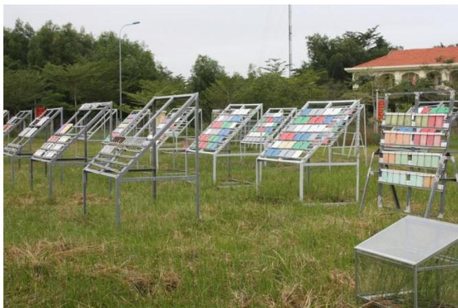
Рисунок 4.8 – Внешний вид образцов на открытой площадке
