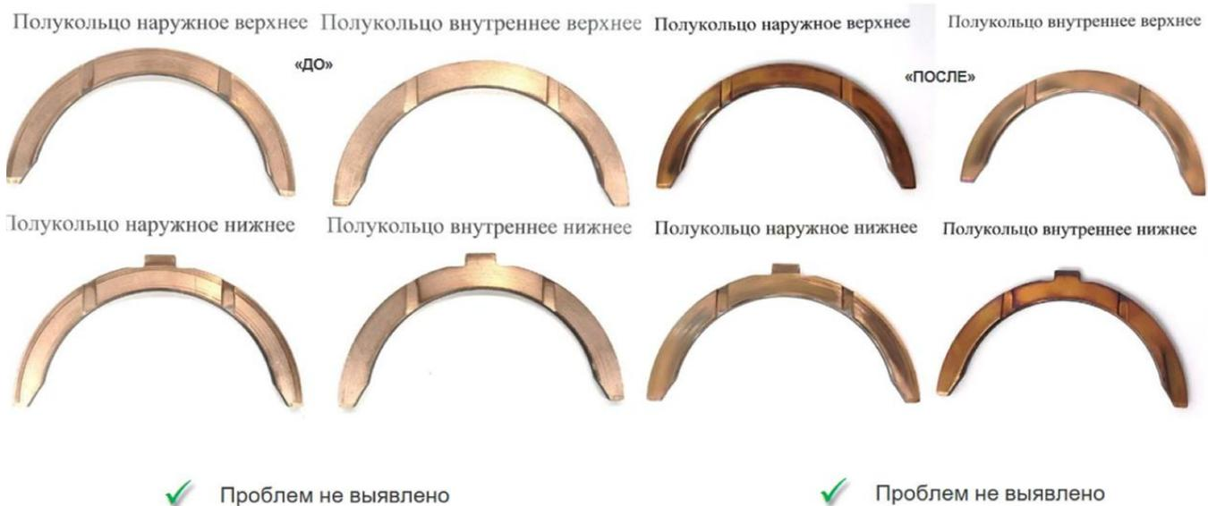
Рисунок 4.16 – Результаты испытаний упорных полуколец
