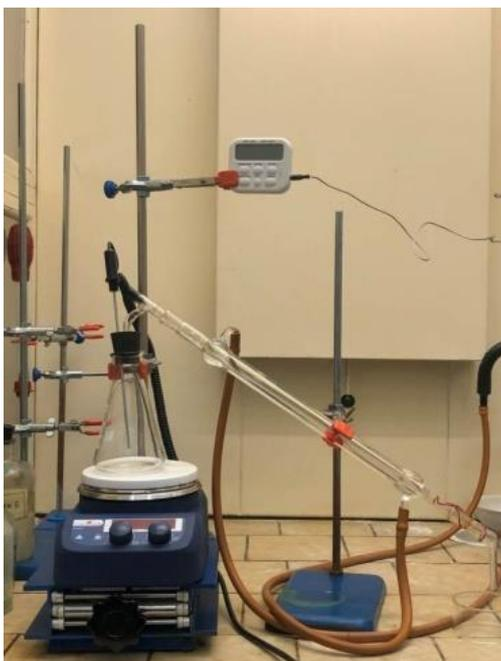
Рисунок 3.1 - Лабораторная установка для синтеза ПАВ (1 – магнитная мешалка с подогревом; 2- стеклянная колба; 3 – холодильник; 4 – емкость для сбора конденсата)
