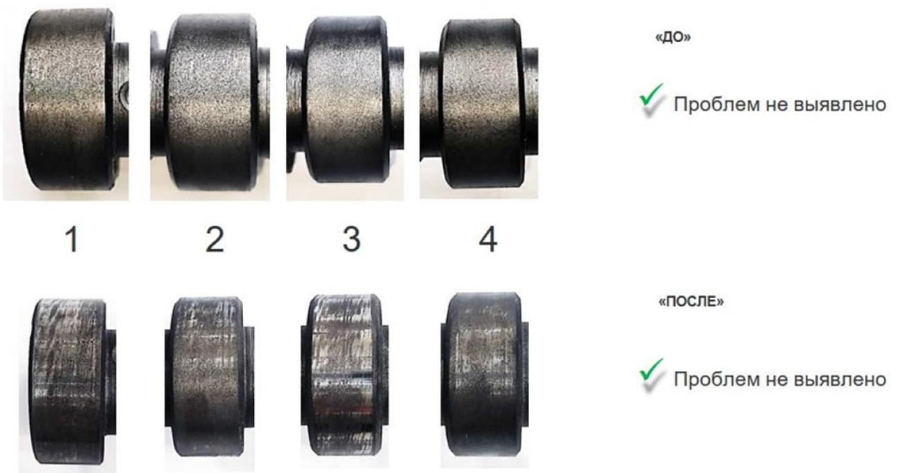
Рисунок 4.19 – Результаты испытаний опорных шеек распределительного вала
