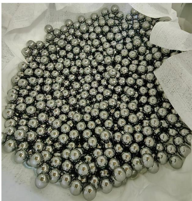
Рисунок 4.29 - образцы шариков из стали ШХ15
