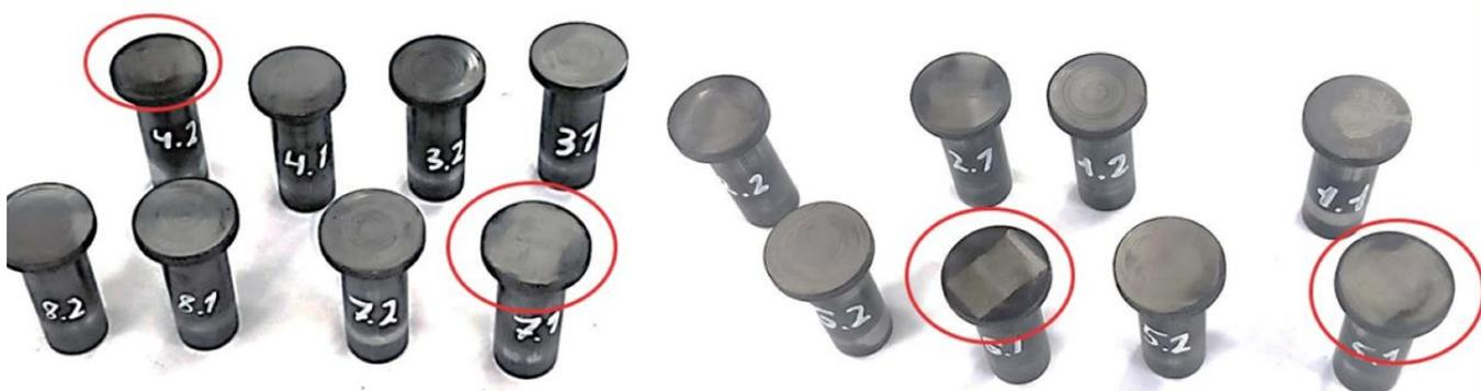
Рисунок 4.20 – Внешний вид толкателей после проведения испытаний
