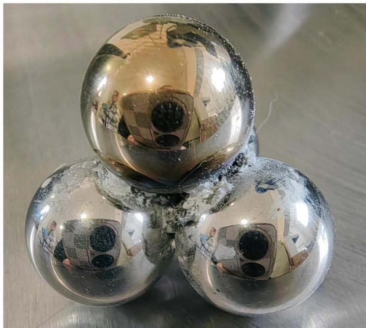
Рисунок 4.33 - Сваривание шариков
