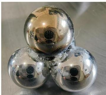
Рисунок 6– Стальные шарики после проведения испытания
