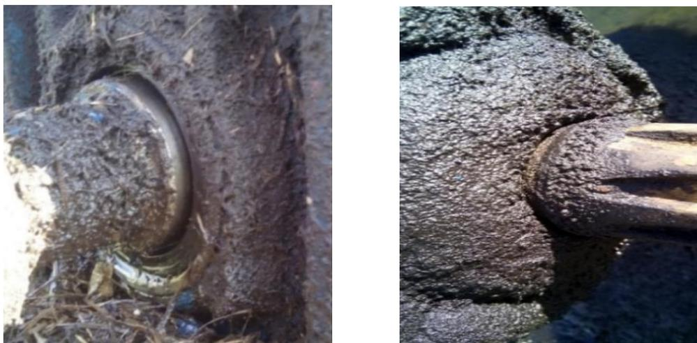
Рисунок 1.6 – Внешний вид агрегатов сельскохозяйственной техники при нарушении герметичности уплотнений подшипниковых узлов
