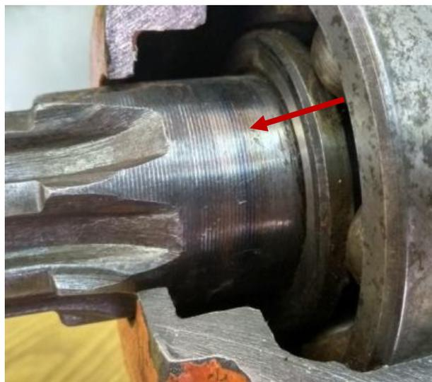
Рисунок 1.16 – Некачественная обработка поверхности вала под манжету
