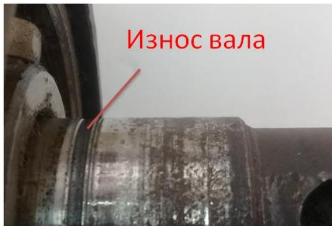
Рисунок 1.7 – Износ вала
