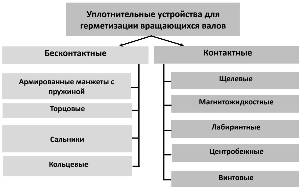
Рисунок 1.11 – Классификация уплотнительных устройств
