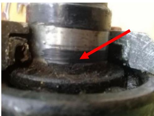
Рисунок 1.9 – Наволакивание резины на вал
