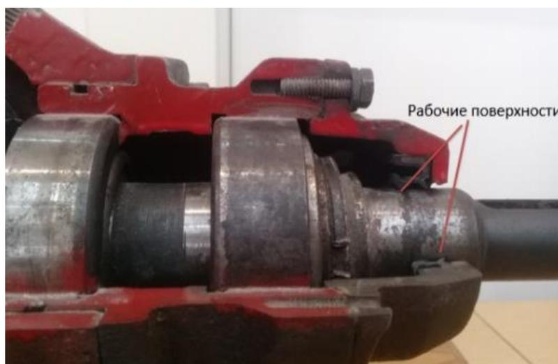
Рисунок 1.10 – Коррозия рабочей поверхности вала в зоне контакта с манжетой
