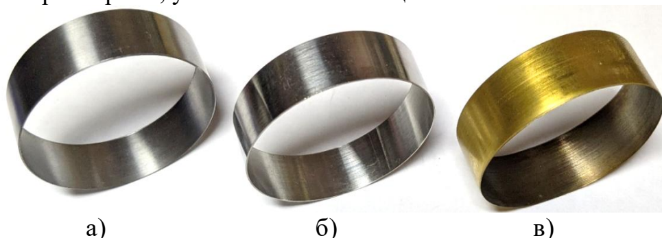
Рисунок 9 – Тонкостенная ремонтная втулка: а) без упрочнения; б) с упрочнением рабочей поверхности ХТВ21; в) с упрочнением рабочей поверхности TiN
