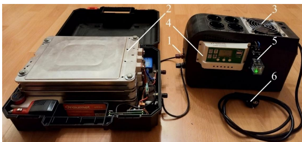
Рисунок 4.9 – Модернизированный ИБП с батареями из аккумуляторных модулей электромобиля Nissan Leaf без солнечной батареи
