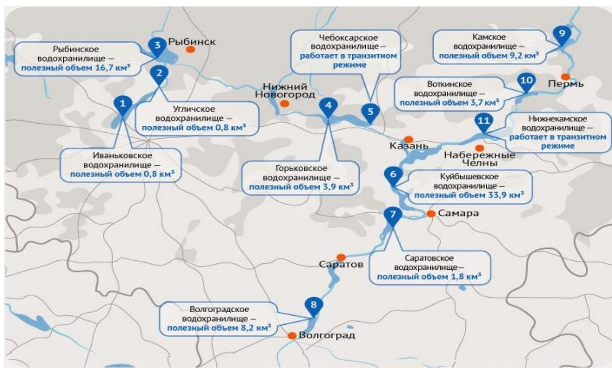
Рисунок 1.5 – Схема Волжско-Камского каскада водохранилищ на реке Волге
