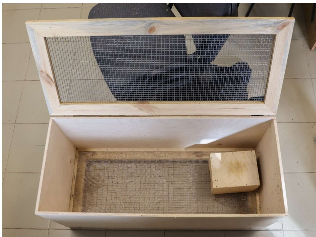
Рисунок 9 – Экспериментальная клетка-ящик для проведения балансового опыта
