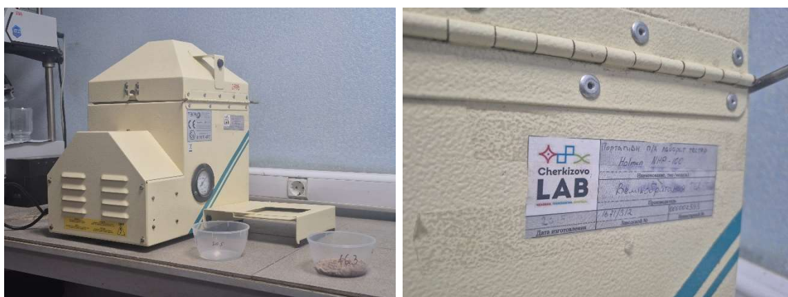
Рисунок 12 – Прибор для определения крепости гранул комбикорма «Holmen NHP-100»: общий вид (слева) и маркировка (справа)
