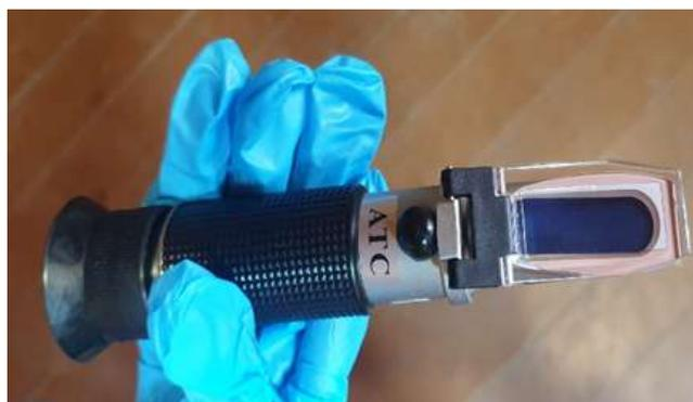
Рисунок 5 – Оптический рефрактометр
