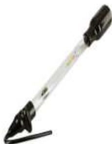
Рисунок 3 – Колострометра
