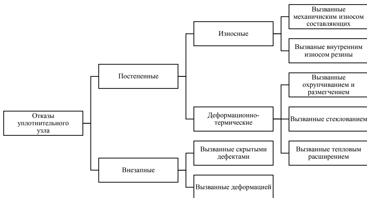
Рисунок 1.9 – Причины отказов уплотнительного узла
