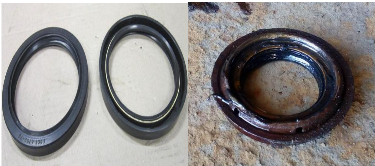
Рисунок 1.8 – Армированная манжета: а – новая; б – изношенная
