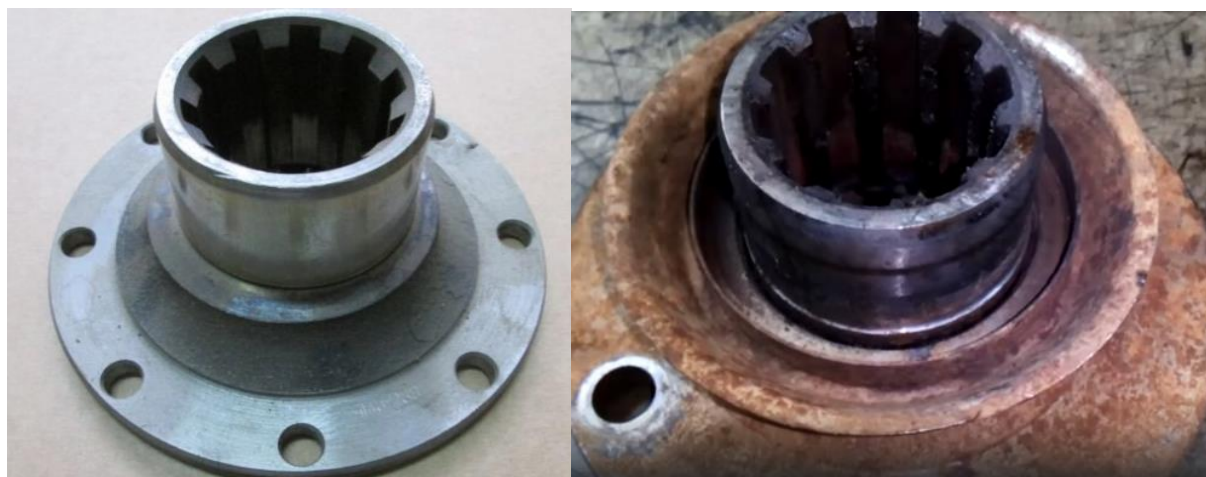
Рисунок 1.7 – Фланец КПП: а – новый; б – изношенный
