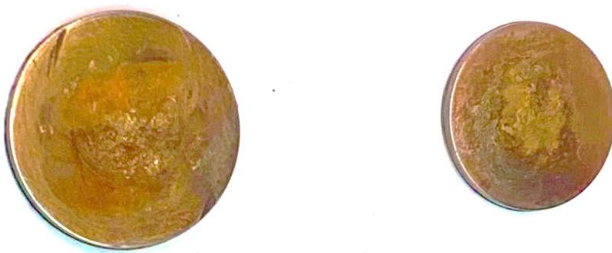
Рис. 3.10 – Специальные образцы с фрикционным медноалюминиевым покрытием
