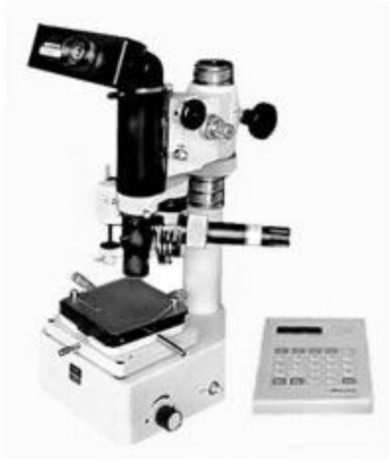
Рисунок 3.12 – Прибор ПМТ-3М для измерения микротвердости поверхностей
