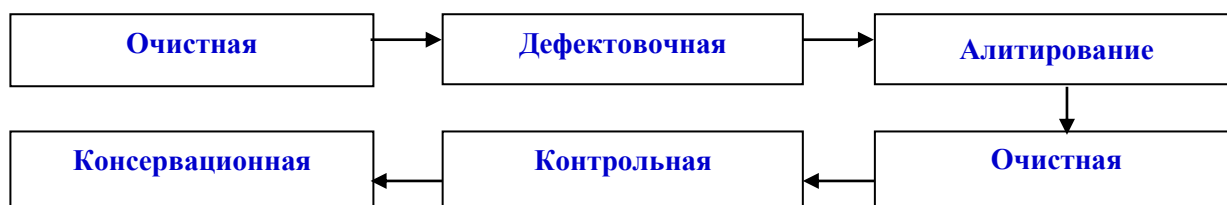
Рисунок 7 – Схема технологического процесса фрикционного алитирования детали типа «вал»
