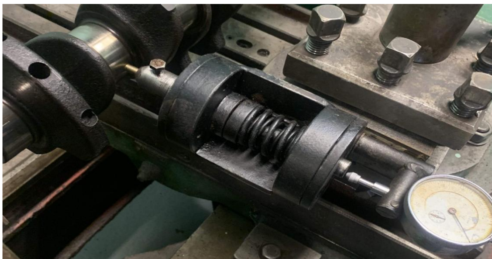
Рисунок 1 – Устройство для отработки технологии фрикционного алитирования
