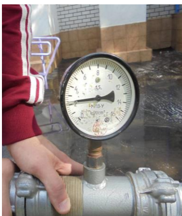
Рисунок 5 – Манометр для определения напора рабочего потока перед струйным аппаратом
