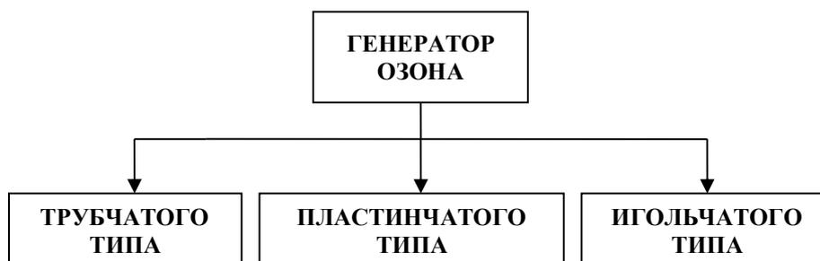
Рисунок 1.6 - Классификация генераторов озона
