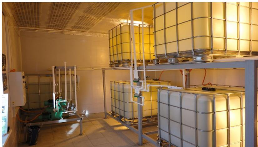
Рисунок 1.1 – Биореактор для выращивания хлореллы с интенсивным перемешиванием, поддержанием оптимальной температуры и освещением
