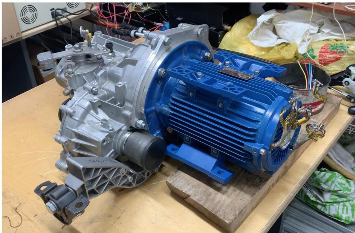
Рисунок 2.12 – Комплект для установки на автомобиль Лада Гранта с электродвигателем АИР 112 от «Z-ion Controllers» [210]
