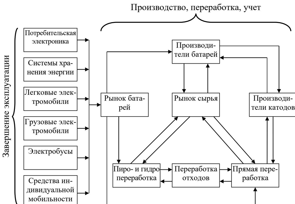
Рисунок 1.13 – Структура обращения с выбывшими из эксплуатации литий-ионными батареями из различных источников
