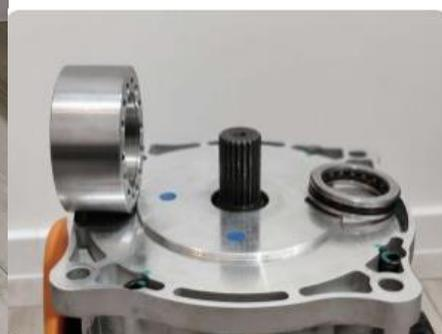
Рисунок 2.9 – Адаптер для присоединения 15/30 кВт 96 В электродвигателя переменного тока к трансмиссии от EV Evolution [203]
