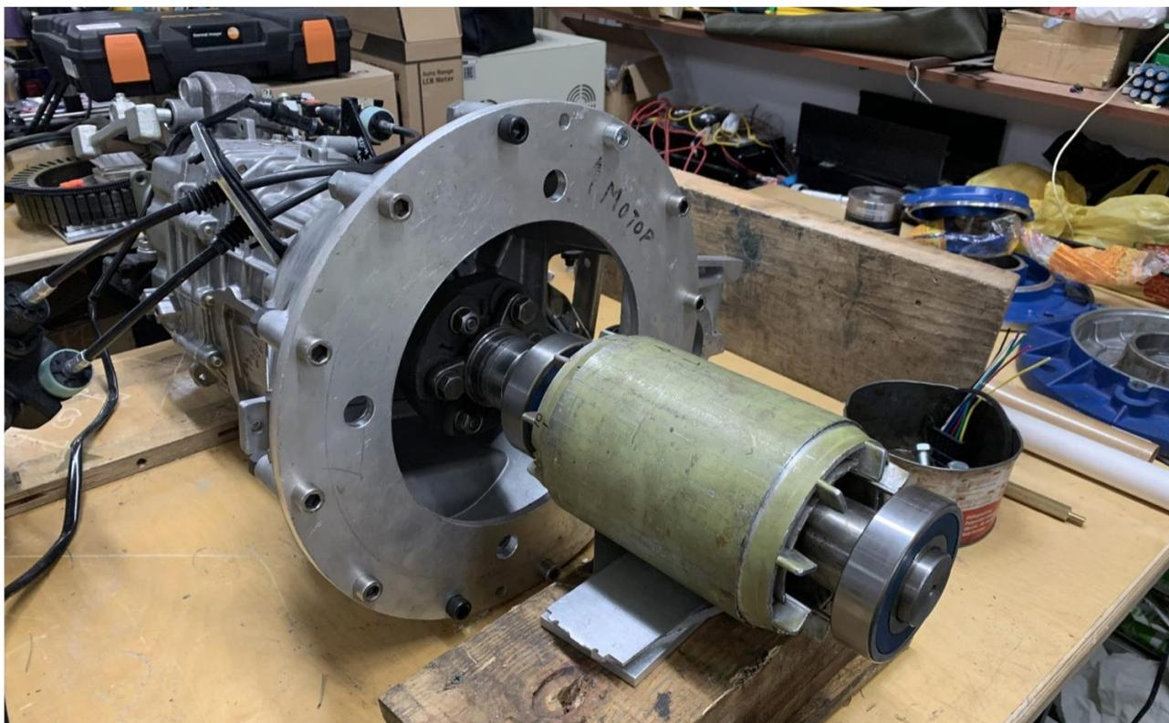
Рисунок 2.13 – Ротор электродвигателя АИР 132 и переходная планшайба, присоединенные к КПП автомобиля Газель Некст от «Z-ion Controllers» [210]
