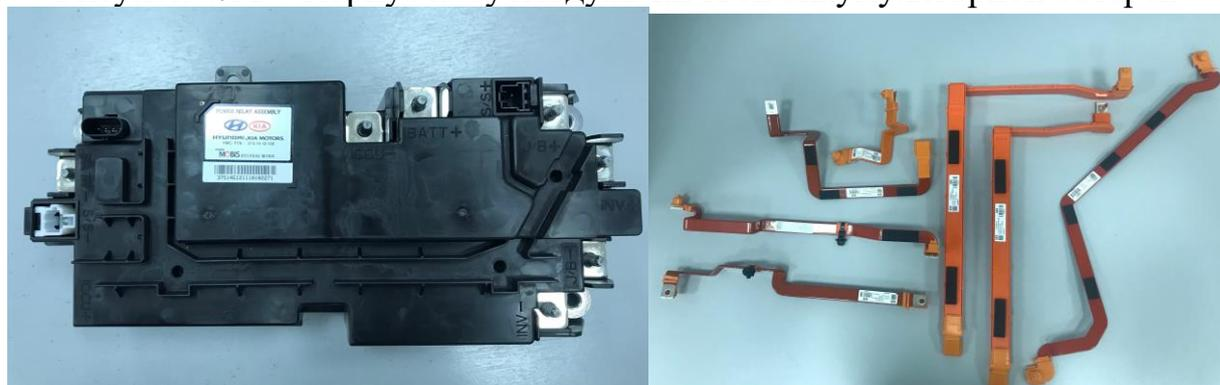
Рисунок 4.12 – Блок силового реле (PRA) и силовые токоведущие шины тяговой аккумуляторной батареи
