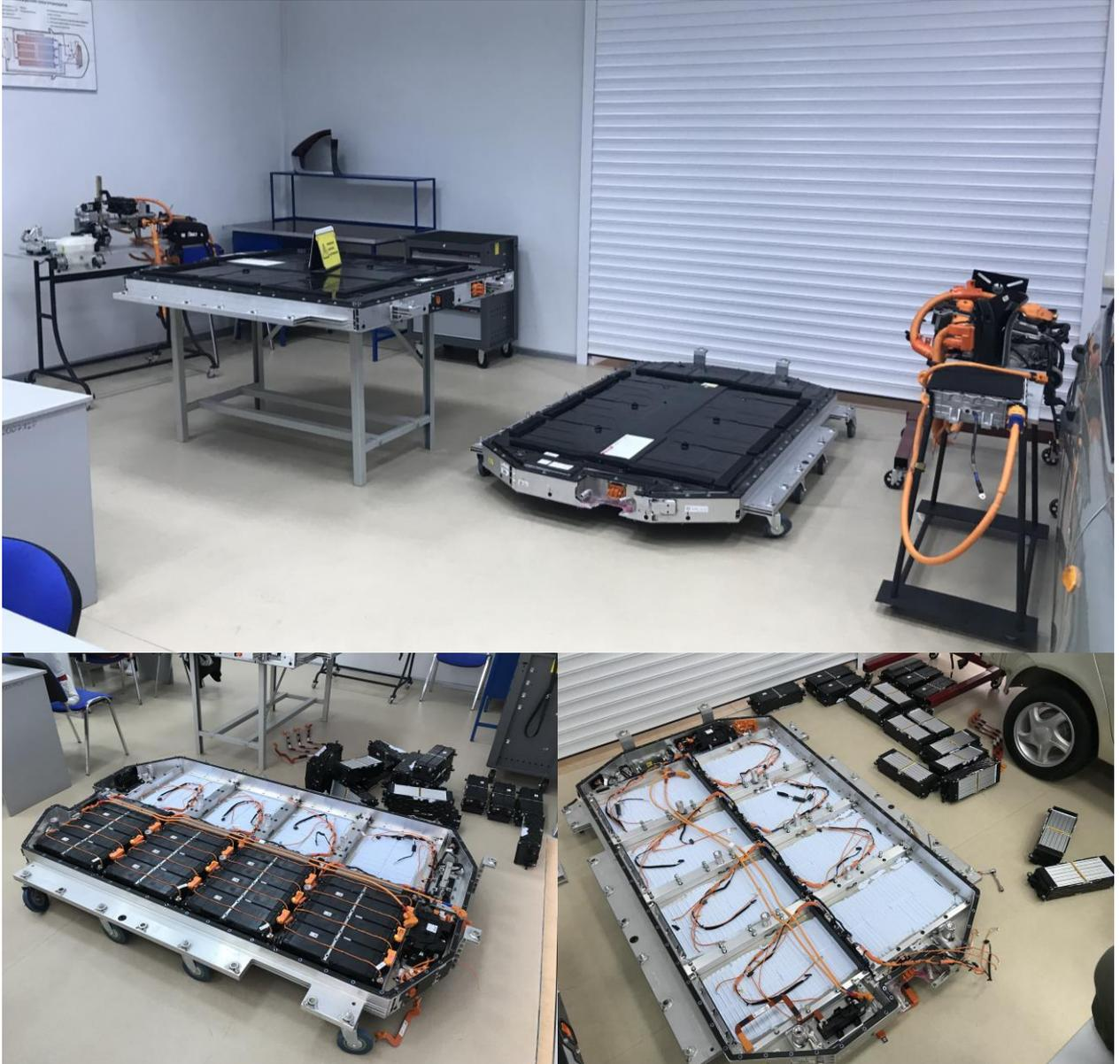
Рисунок 3.19 – Общий вид рабочего места и этапы работы с высоковольтной аккумуляторной батареей
