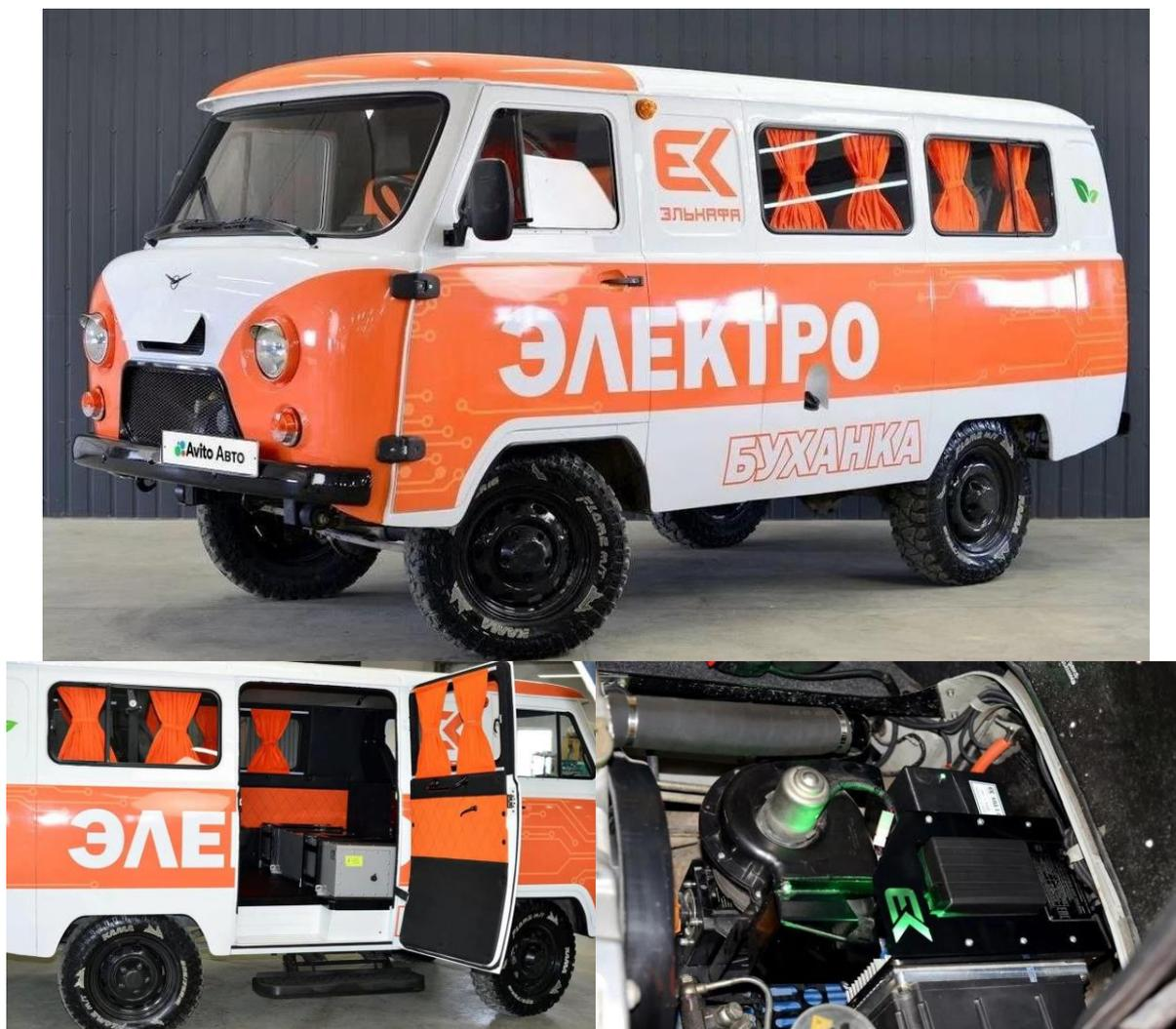
Рисунок 2.15 – Экспериментальный электромобиль «ЭлектроБуханка» ООО Научно-производственное предприятие «Эльтавр»: общий вид (сверху), вариант установки тяговой батареи (внизу слева), моторный отсек (внизу справа) (фотографии с сайта «Авито») [213]
