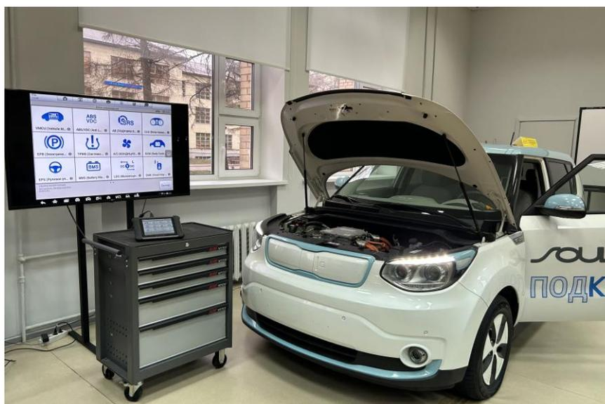
Рисунок 3.14 – Рабочее место мастера диагноста электромобилей в лаборатории кафедры «Тракторы и автомобили»
