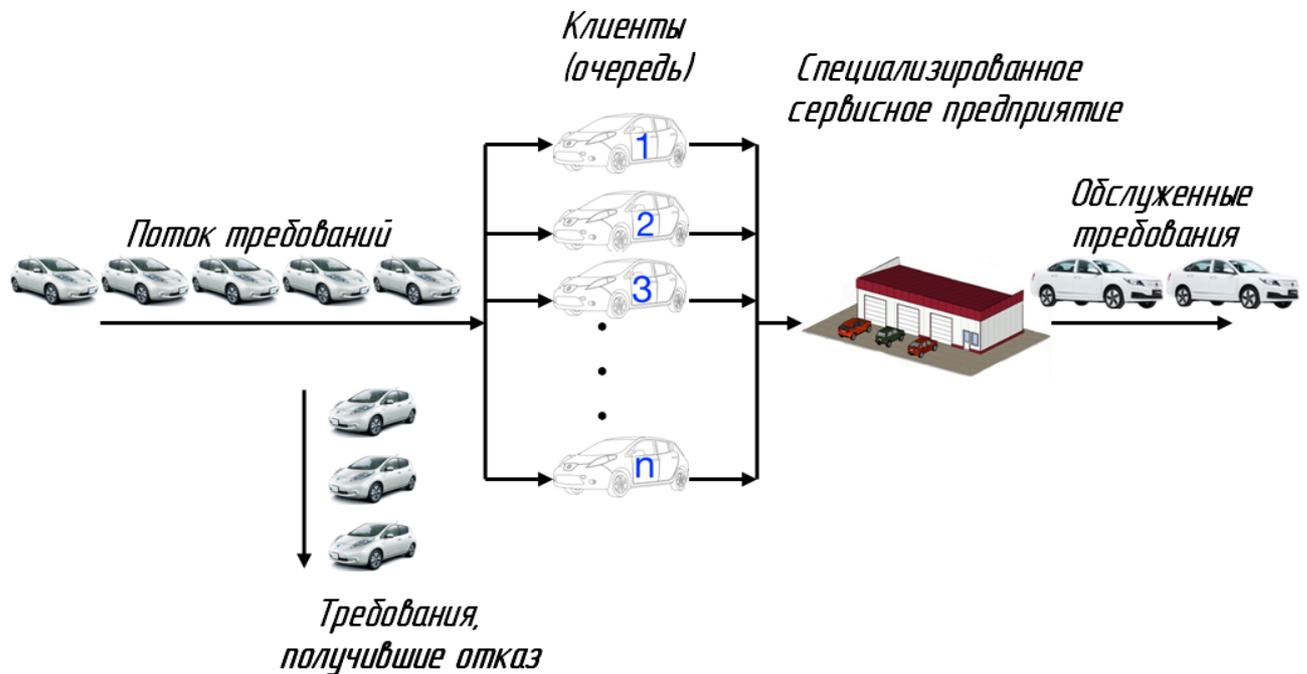
Рисунок 2.20 – Принципиальная схема взаимодействия специализированного сервисного предприятия технического обслуживания и ремонта электромобилей с клиентами
