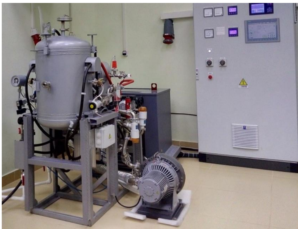
Рисунок 3.2. – Печь СШВЭ-1.2 для вакуумного отжига
