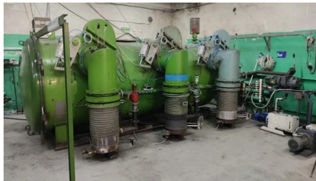
Рисунок 3.3. – Вакуумная установка для получения тонкоплёночных покрытий из нитрида титана. Общий вид сбоку (а) и система насосов с газовыми магистралями на задней панели камеры (рис. б).
