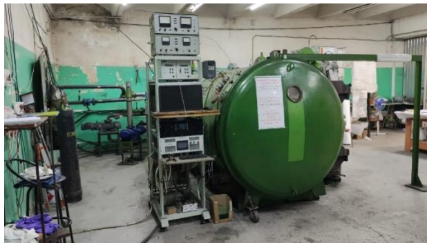
Рисунок 3.3. – Вакуумная установка для получения тонкоплёночных покрытий из нитрида титана. Общий вид сбоку (а) и система насосов с газовыми магистралями на задней панели камеры (рис. б).
