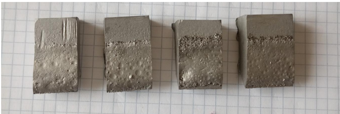
Рисунок 3.1. – Подготовленные образцы с выраженной зоной наплавки износостойкого сплава
