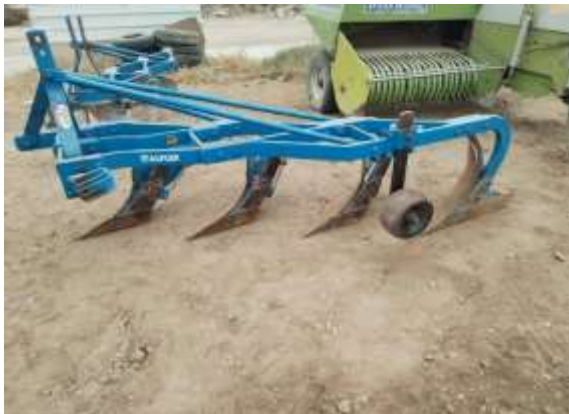
Рисунок 3.5 – Сельскохозяйственная машина для вспашки
