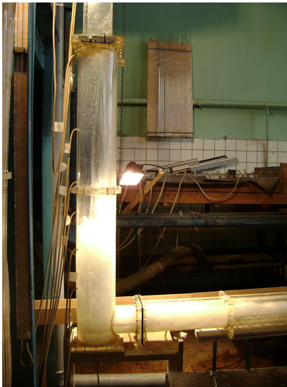
Рисунок 4.12 - Картина движения потока в вертикальной шахте и на начальном участке отводящего туннеля с относительным открытием правого затвора a/a_0=1 и с подачей воздуха за затворной камерой при расходе Q=1400 \text{ м}^3/\text{с}
