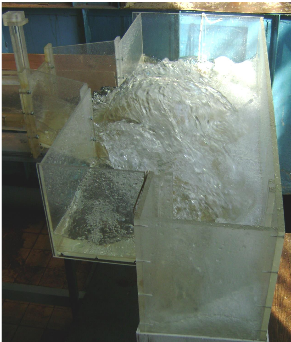
Рисунок 4.45 - Картина движения воды в сопрягающем сооружении при подаче воздуха Q_a=34 \text{ м}^3/\text{с} , Q=1700 \text{ м}^3/\text{с} , a/a_o=0.5
