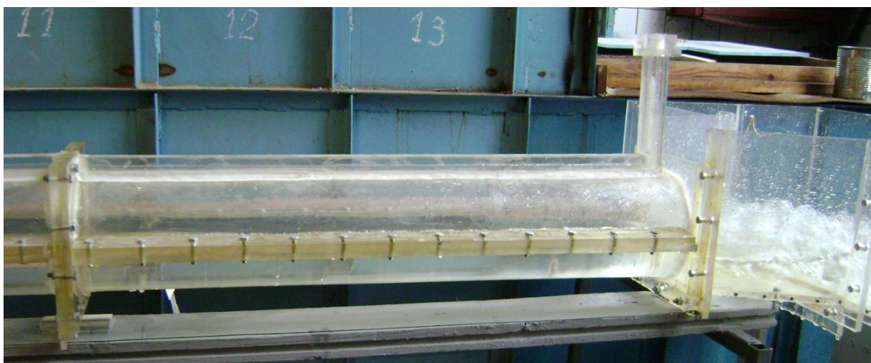
Рис. 4.29. Картина движения воды на концевом участке отводящего туннеля при подаче воздуха. Q=620 \text{ м}^3/\text{с} , a/a_0=0.3
