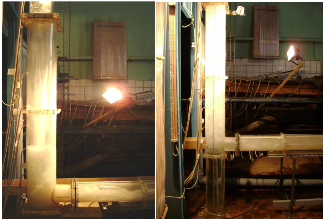
Рисунок 4.39 - Картина движения воды в зоне примыкания отводящего туннеля к шахте при подаче воздуха Q_a=4 \text{ м}^3/\text{с} , Q=180 \text{ м}^3/\text{с} , a/a_0=0,1
