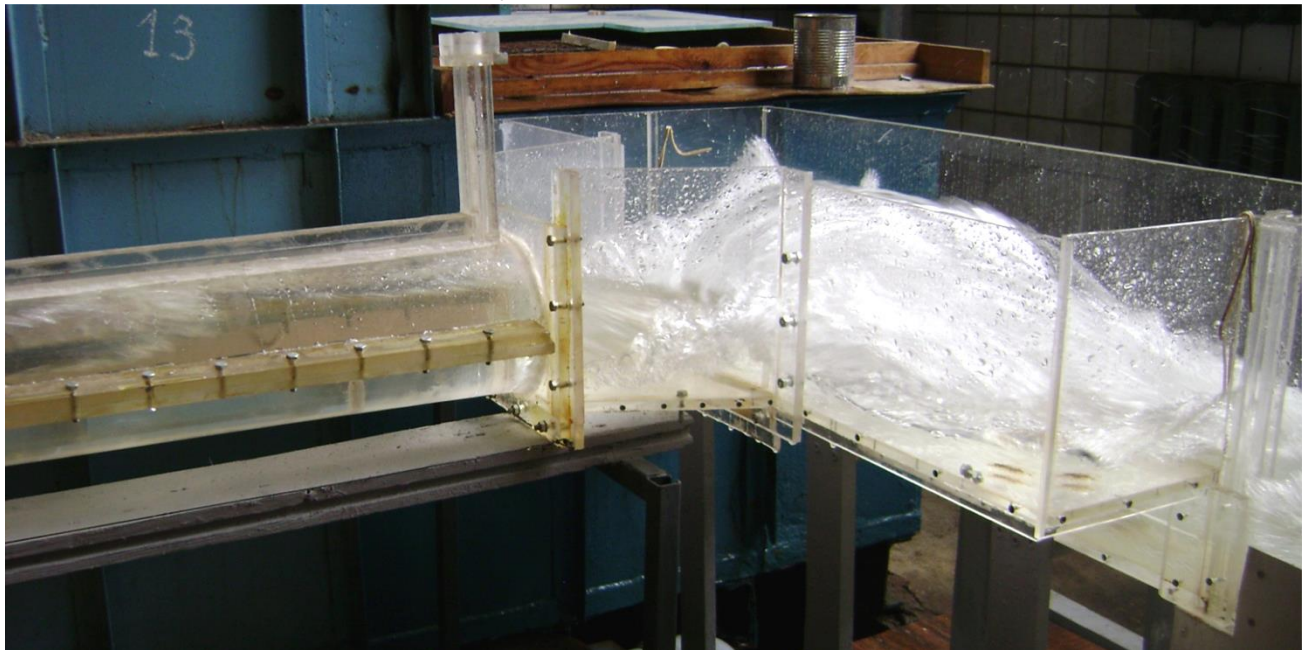
Рис. 4.33. Картина движения воды на конечном участке отводящего туннеля при подаче воздуха. Q=1820\text{ м}^3/\text{с} , a/a_0=0.8
