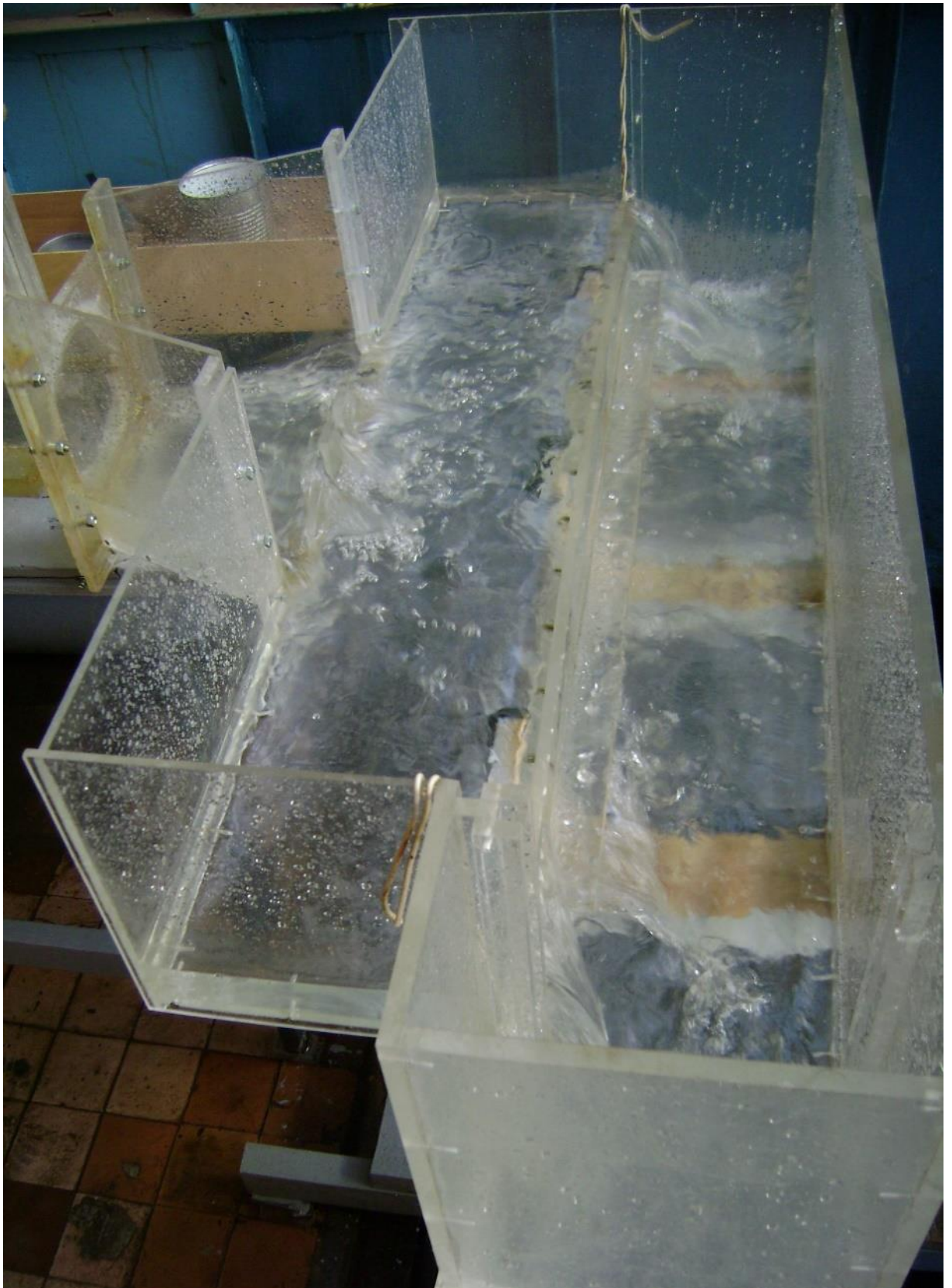
Рисунок 4.20 - Картина движения воды на сопрягающем участке при работе левым затвором с относительным открытием a/a_0=0,5 и с подачей воздуха.
