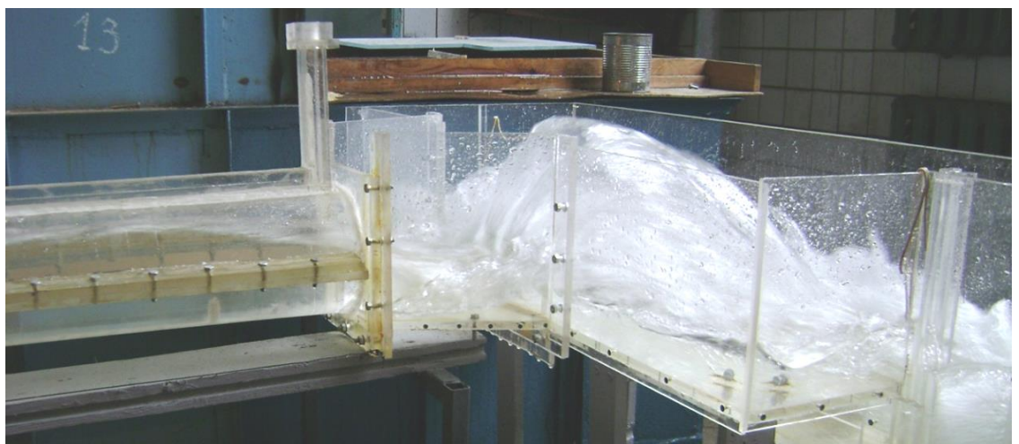
Рис. 4.48. Картина движения воды на концевом участке отводящего туннеля при подаче воздуха Q_a=67 \text{ м}^3/\text{с} , Q=3130 \text{ м}^3/\text{с} , a/a_0=1
