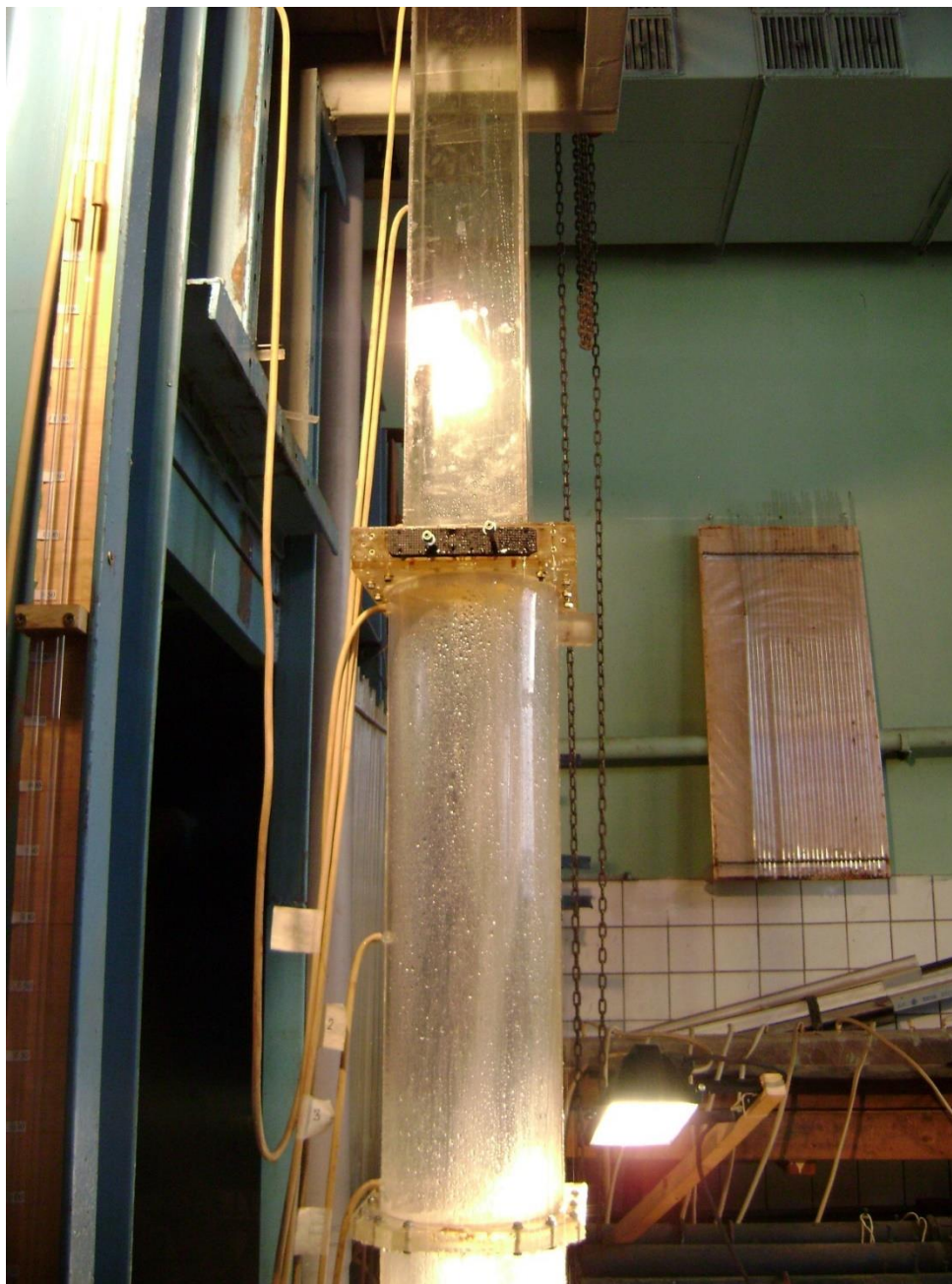
Рисунок 4.21 - Правый затвор с относительным открытием a/a_0=0,5 и с подачей воздуха. Расход Q=770 м 3 /с. Вид струи за затвором
