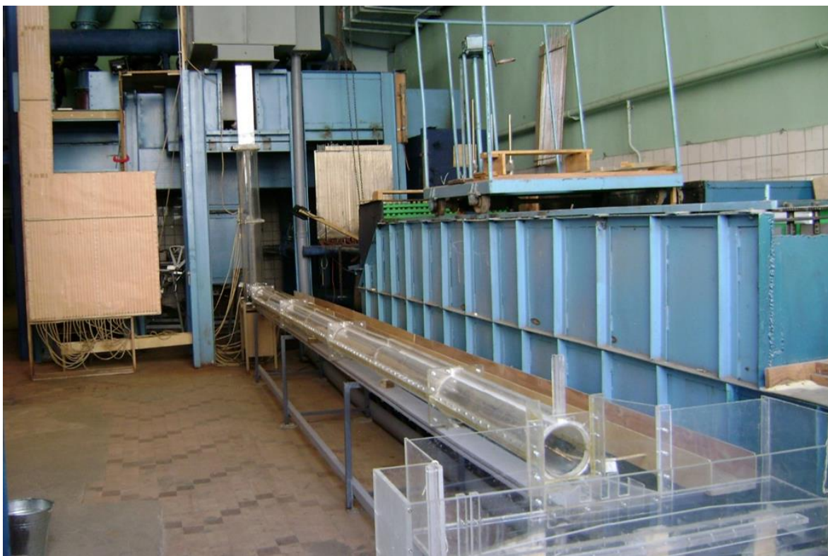
Рисунок 3.5 - Модель сопрягающего участка с прорезной стенкой
