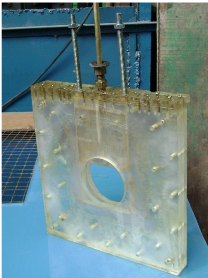
Рисунок 3.10 - Фото конструкции затворной камеры с круглым отверстием ( d=5 см)
