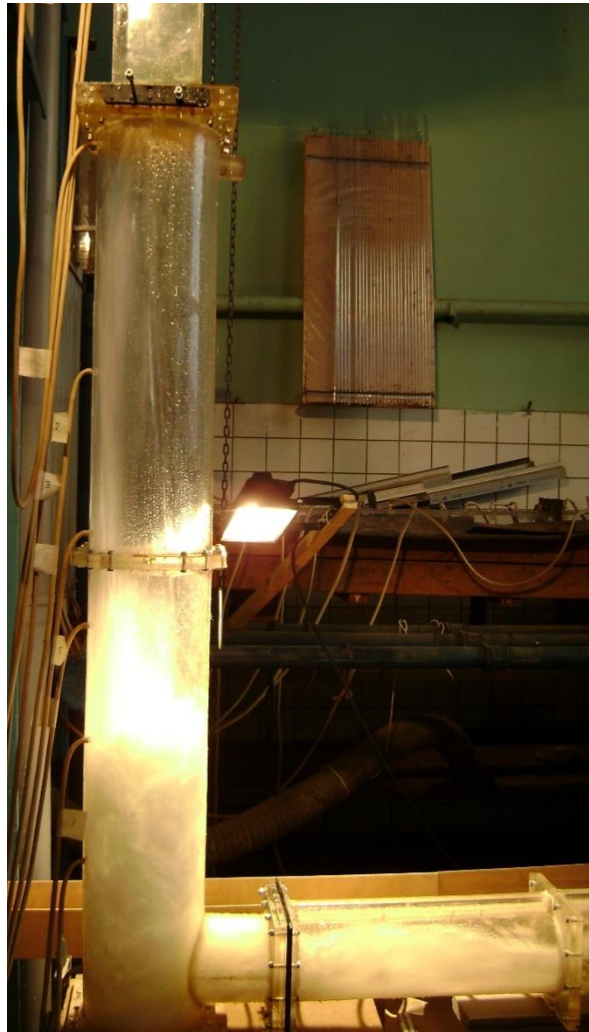
Рисунок 4.9 - Левый затвор с относительным открытием a/a_0=1 и с подачей воздуха. Расход Q=1400 \text{ м}^3/\text{с}
