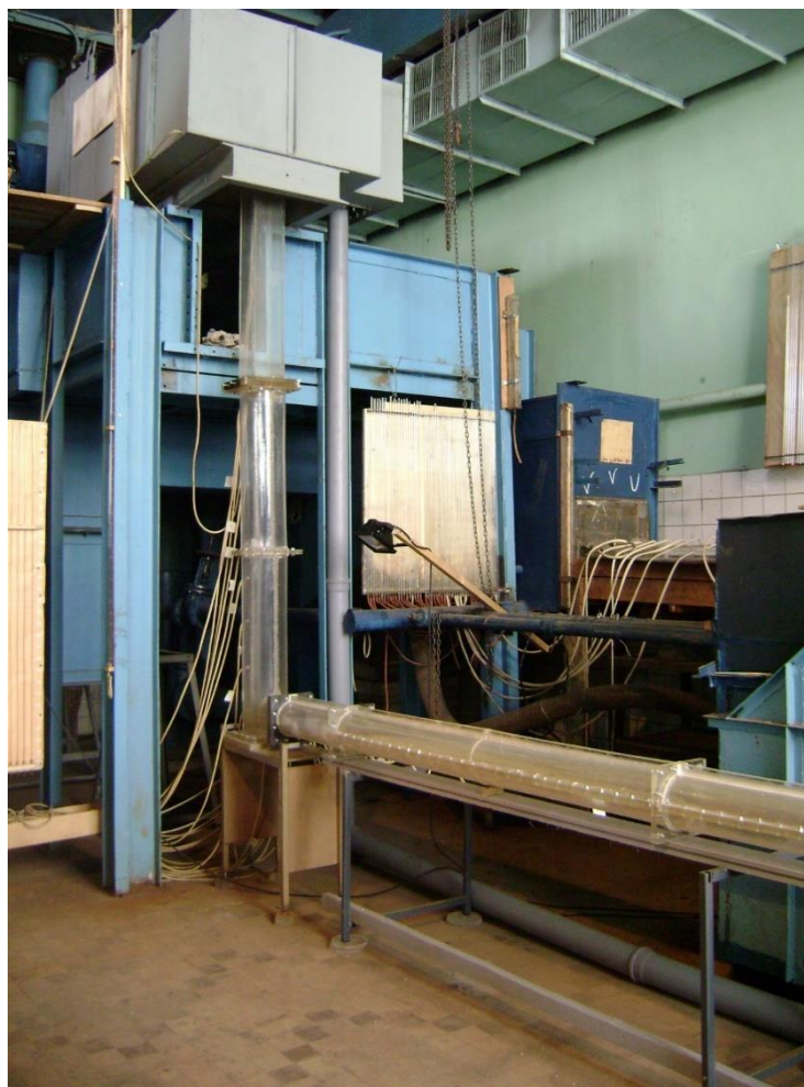
Рисунок 3.7 - Головной участок и отводящий туннель модели (фото)
