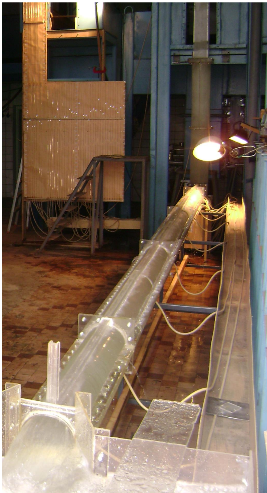
Рисунок 3.14 - Размещение пьезометров на отводящем туннеле (фото)
