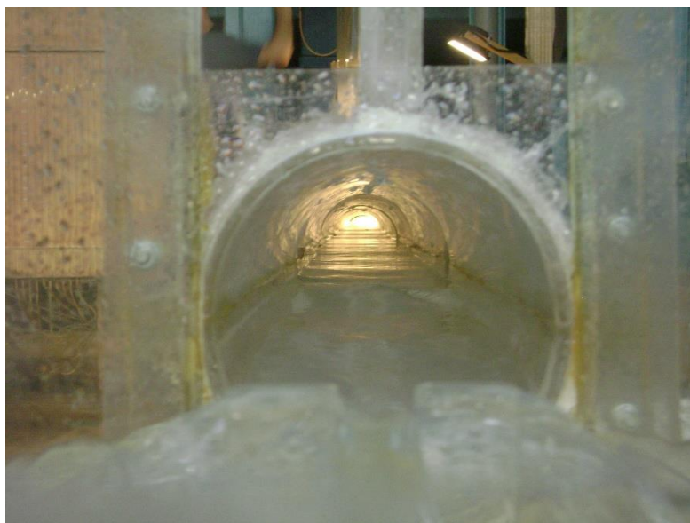
Рисунок 4.23 - Картина движения воды в туннеле при работе правым затвором с относительным открытием a/a_0=0,5 и с подачей воздуха.
