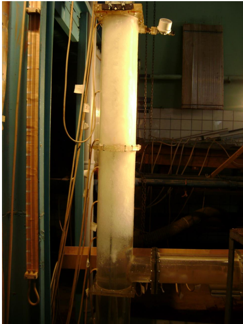
Рисунок 3.12 - Схема размещения пьезометров на модели водосбросного туннеля
