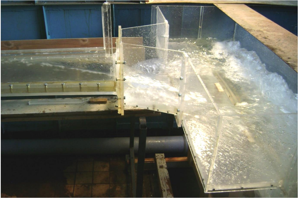
Рисунок 4.4 - Работа сопрягающего участка с распределительной стенкой при расходе Q=2000 \text{ м}^3/\text{с}
