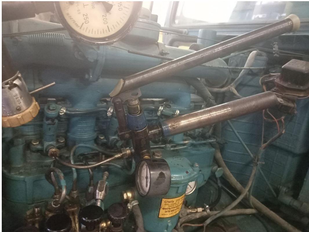
Рисунок 3.10 — Регулировка давления впрыска прибором КИ-16301
