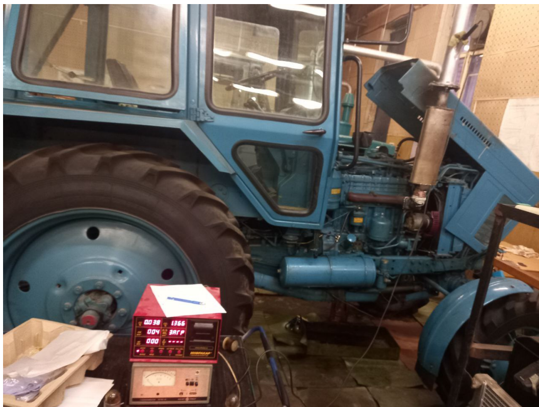
Рисунок 4.1 — Подключение газоанализатора к двигателю Д-240
