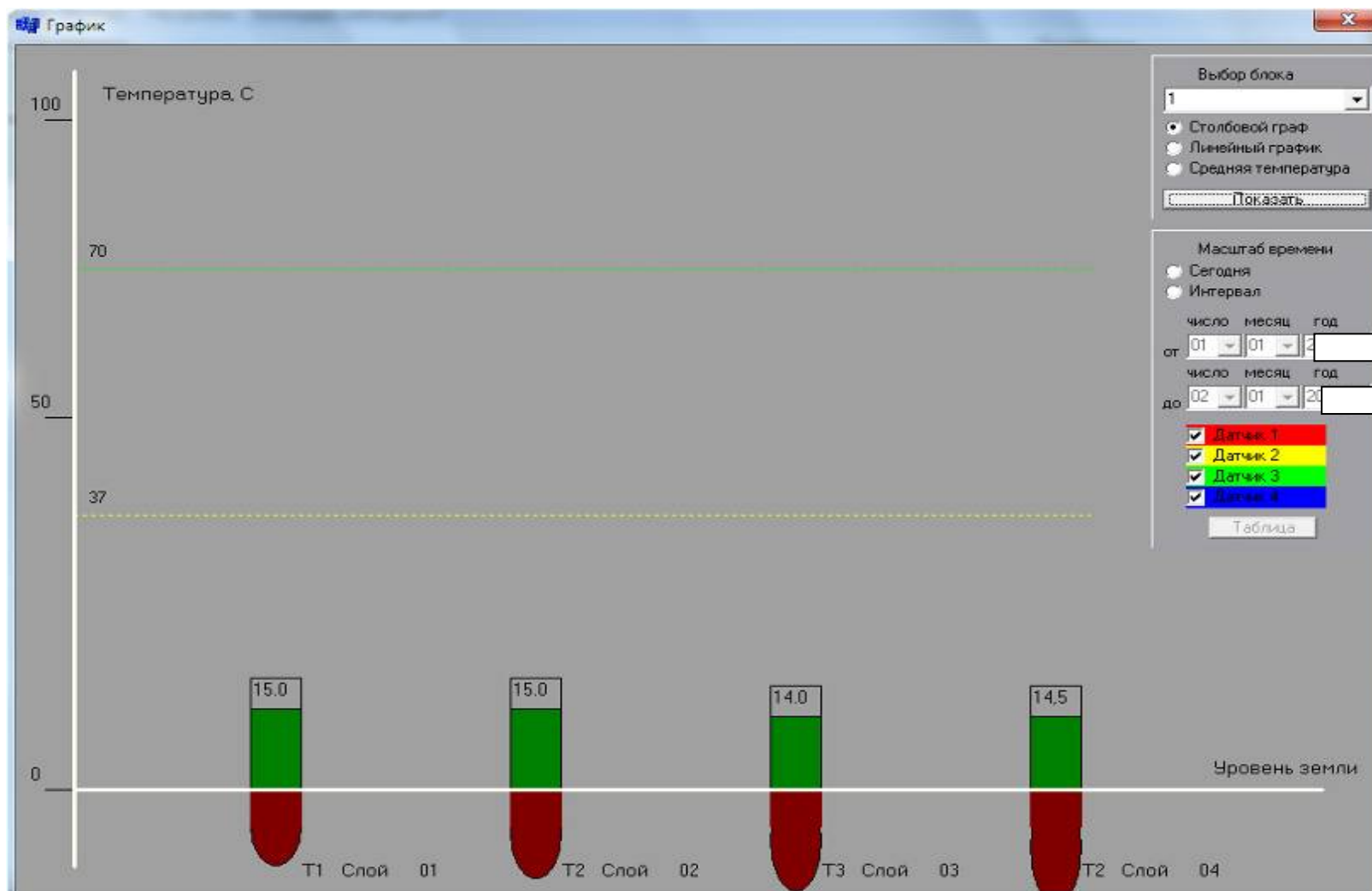
Рисунок 52 - Столбовой график отображения степеней пожарной опасности торфяника по слоям в момент замера
