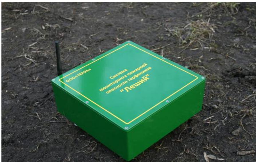
Рисунок 48 - Контроллер возгораний «Леший» - стационарный вариант, размещаемый на местности
