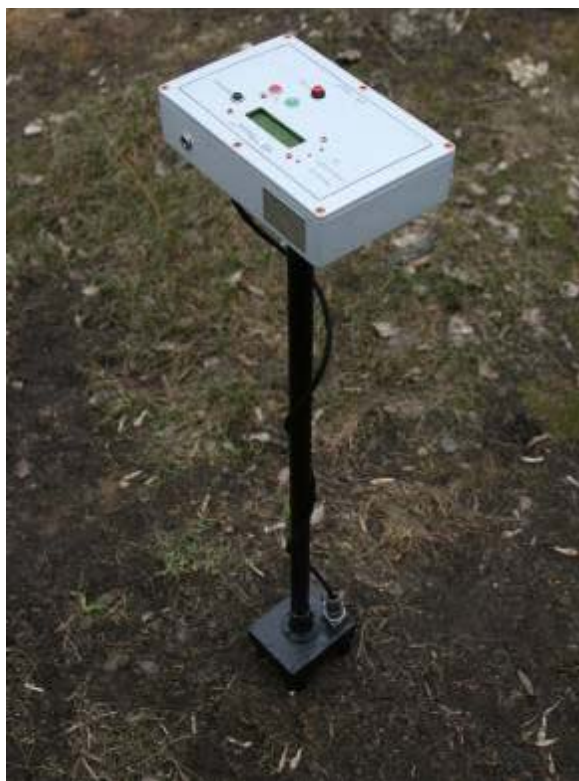
Рисунок 47 - Контроллер возгораний «Леший» - мобильный вариант для обходчиков и патрулей
