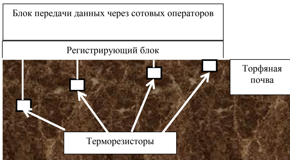
Рисунок 15 – Схема устройства для мониторинга за состоянием торфяника
