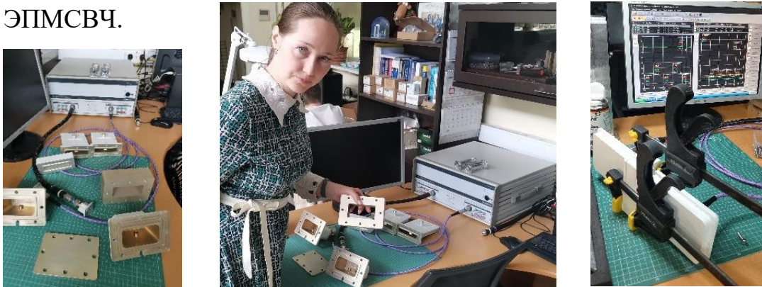
Рисунок 4.33 – Исследования для определения диэлектрической проницаемости сыра волноводным методом
