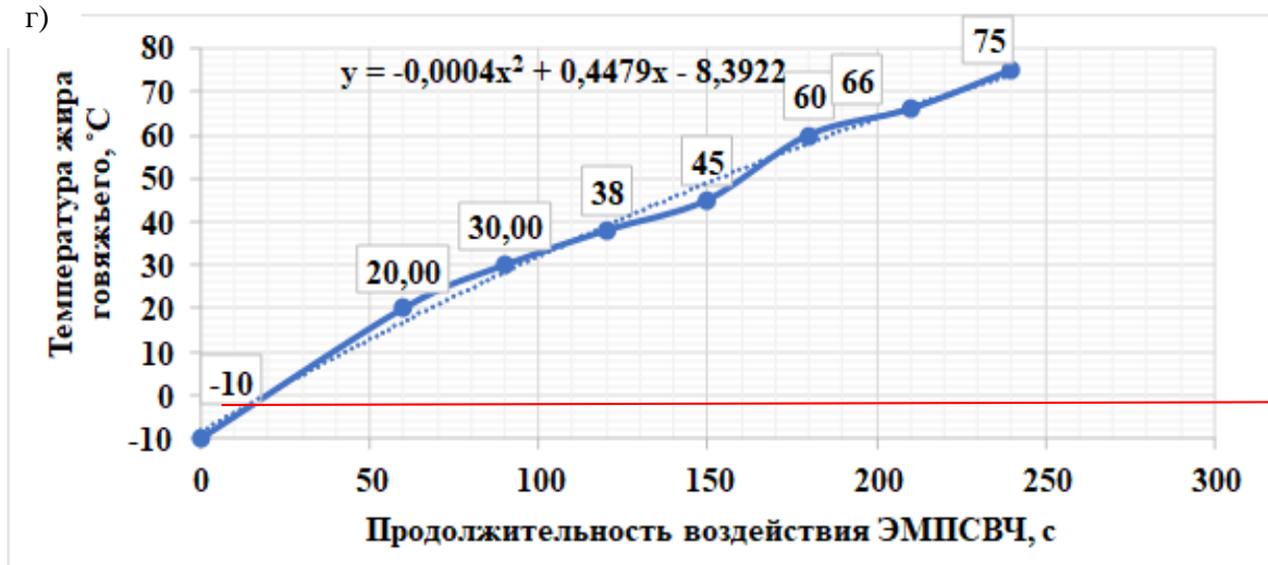
Рисунок 9.16 – Результаты экспериментальных исследований динамики диэлектрического нагрева: а) крови убойных животных, при удельной мощности генератора 1,6 Вт/г; б) сливочного масла, жирностью 82,5 %, при удельной мощности генератора 4,4 Вт/г; в) печени куриной, при удельной мощности генератора 1,6 Вт/г; г) жира говяжьего, при удельной мощности генератора 1,6 Вт/г
