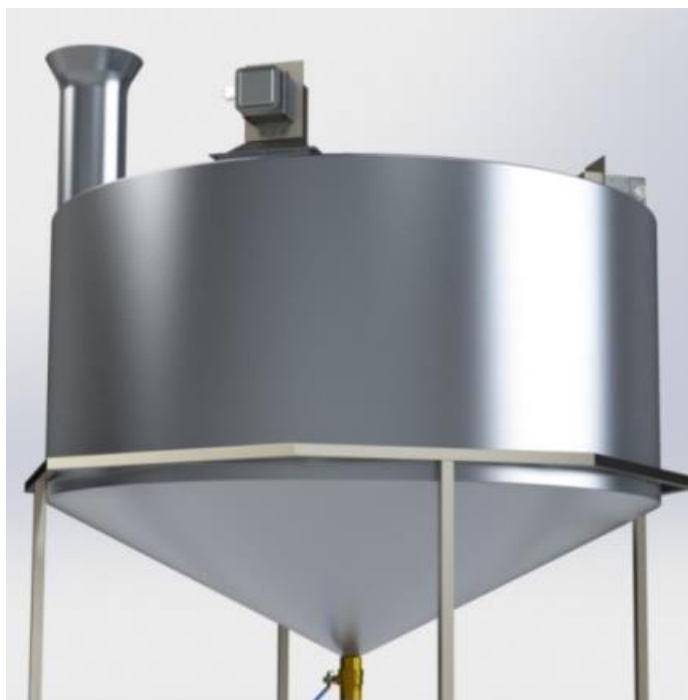
Рисунок 2.32 – Модель СВЧ-размораживателя с состыкованными коаксиальным и коническим резонаторами
