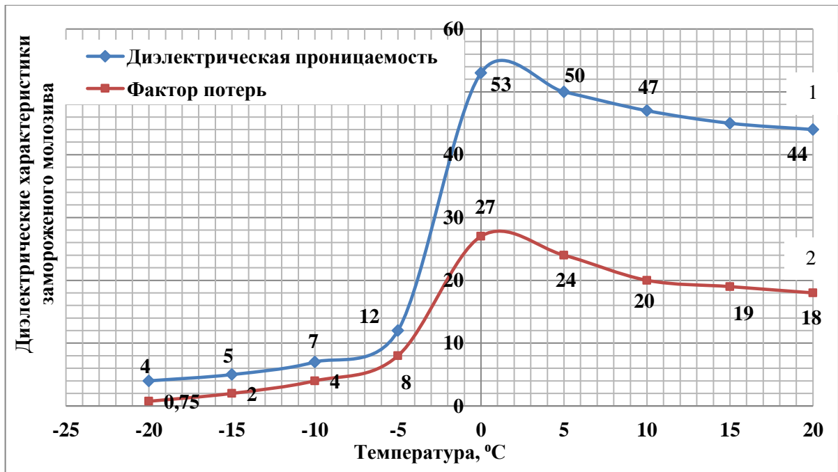
Рисунок 2.2 – Диэлектрические характеристики коровьего молозива жирностью 6,4 % при изменении температуры от -25\text{ }^{\circ}\text{C} до 20\text{ }^{\circ}\text{C} : 1 – диэлектрическая проницаемость; 2 – фактор диэлектрических потерь
