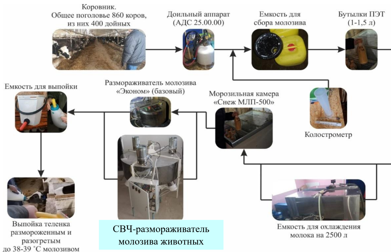
Рисунок 19 – Машинно-аппаратная схема подготовки молозива к выпойке телятам на ферме КРС ООО «АП Княгининское», Нижегородская область
